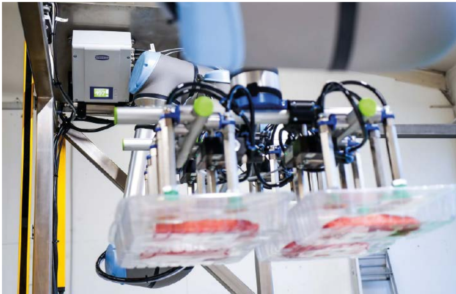
■ Abb. 2: Die Compact Pump GCPI (oben links) stellt das benötigte Vakuum rein elektrisch zur Verfügung.
