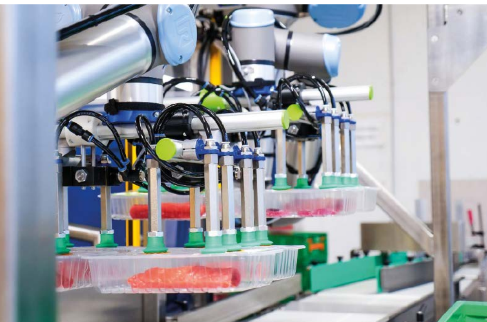
■ Abb. 1: Die Balgsauggreifer PSPF der automatischen Lösung schaffen 96 Picks pro Minute und picken selbst unregelmäßig geformte Oberflächen zuverlässig. Verglichen mit der früheren manuellen Tätigkeit erhöhte der Fleischverarbeiter seinen Output deutlich.
