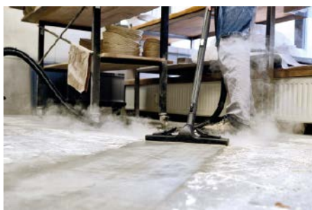
■ Abb. 2: Dank heißem Trockendampf sind Mehl, Teigreste und andere Anhaftungen schnell beseitigt.
