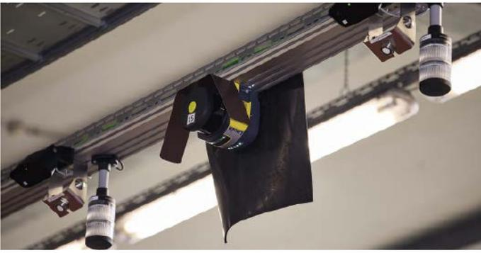
■ Abb. 3: Ein Sicherheits-Laserscanner RSL 400 von Leuze (Mitte) erzeugt ein Schutzfeld im Übergabebereich und deckt zwei Übergabestationen ab. Zusätzlich sind an jeder Station ein Ultraschallsensor sowie ein Radarsensor montiert (links/rechts des Scanners).
