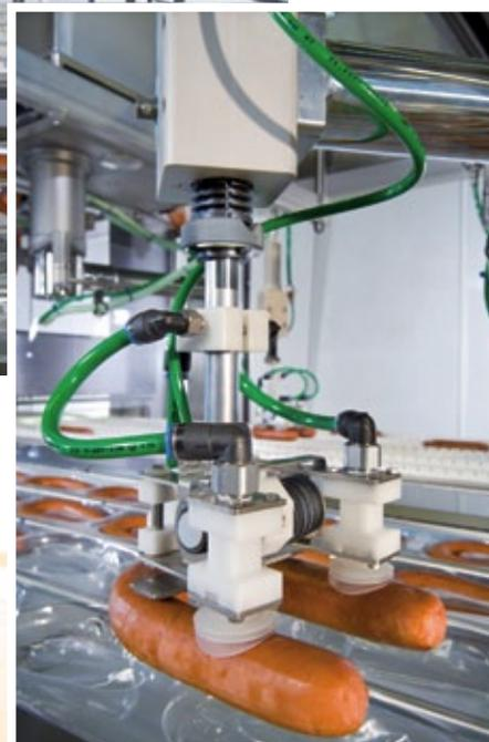
■ Abb. 3: Die Arme der TLM-F4-Roboteraggregate können bis zu 10 G beschleunigen und Geschwindigkeiten von 5 m/s erreichen.
