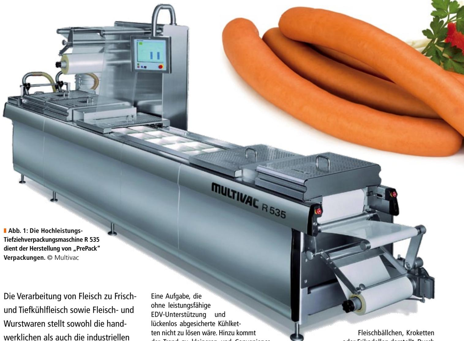
■ Abb. 1: Die Hochleistungs-Tiefziehverpackungsmaschine R 535 dient der Herstellung von „PrePack“ Verpackungen. © Multivac
