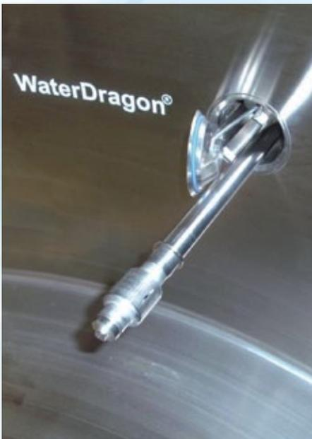
■ **Abb. 2:** Die Lanze des Water Dragon bewegt sich translatorisch in den Mischraum hinein. Bei anliegendem Wasserdruck von ca. 3,5 bar rotiert der Kopf und die Düsen bestrahlen den gesamten Mischraum.
