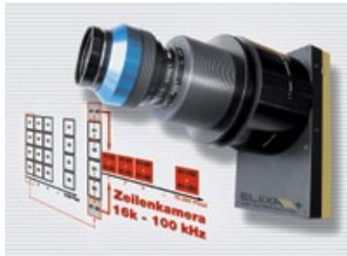
Die ELiIXA+ mit 16.384 Pixel je 5 µm Pixelgröße, wird mit 100 kHz ausgelesen und e2v erreicht eine so gute Sensor-Planarität, dass eine scharfe Abbildung über die gesamte Länge von 82 mm sichergestellt ist. Der Multi-Line CMOS-Sensor garantiert einen Dynamikumfang
