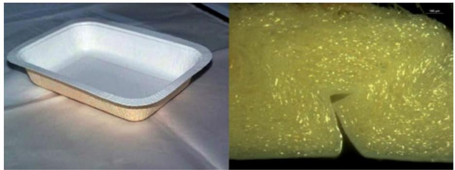
■ Abb. 1: Tiefgezogene Kartonschalen mit Rillung im Randbereich (links) und Mikrotomschnitt einer Falte (rechts).
