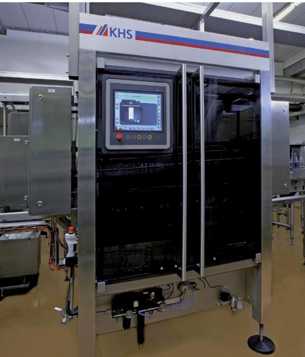
■ Abb. 1: Die Inspektionsleistung des KHS-Leerflascheninspektion-Systems Innocheck EBI beträgt bis zu 60.000 Glasflaschen/h Nennleistung.
