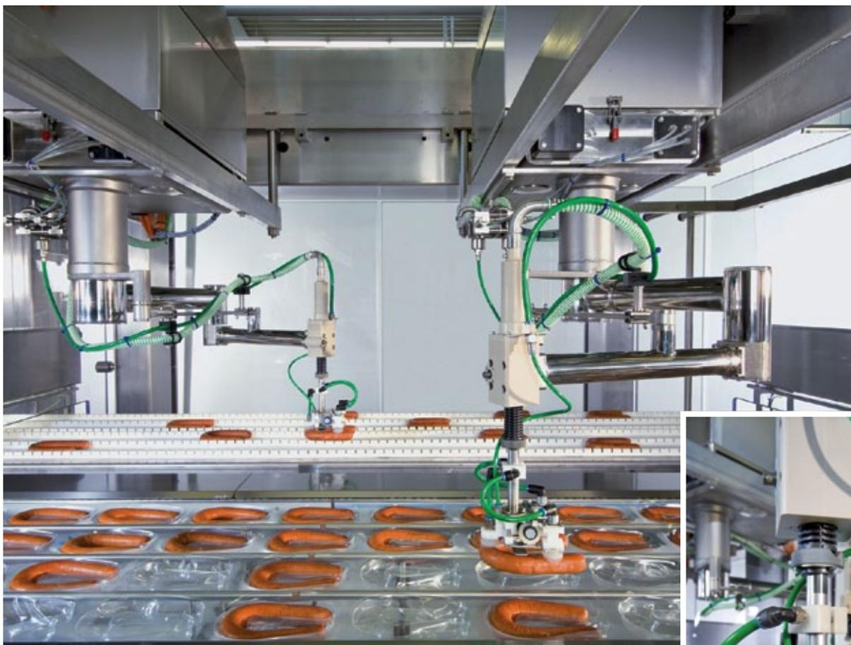
■ Abb. 2: Zum Einsatz kommen zwei TLM-F44-Pickerstationen. In jeder Station arbeiten je zwei TLM-F4-Roboteraggregate.
