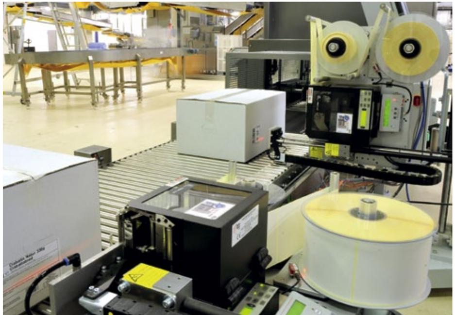
■ Abb. 3: Die Etiketten werden mit variablen Daten bedruckt und im Tamp-Blow-Verfahren per Luftstoß aufgeschossen.
