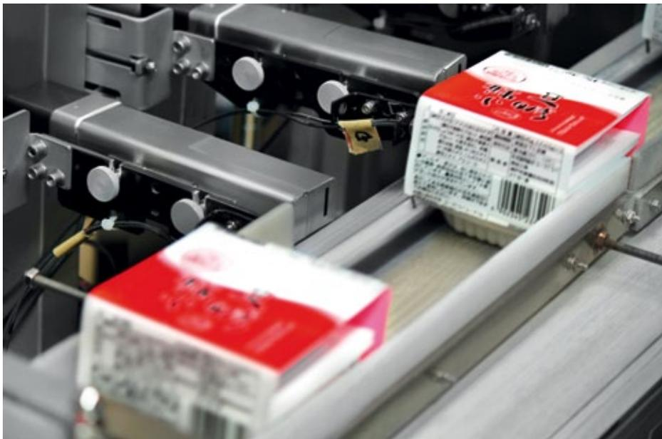
■ Abb. 1: Das Verfallsdatum wird von den Tintenstrahldruckern seitlich direkt auf die Nattô-Schalen aufgebracht.
