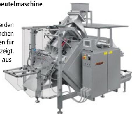
gestellt wird eine 45° geneigte Schlauchbeutelmaschine und Kamerazähleinheit. Die Abbildung zeigt eine Schlauchbeutelmaschine aus dem Standard-Programm der Firma. Bilder der Produktneuheiten zur iba lagen bei Redaktionsschluss noch nicht vor.
