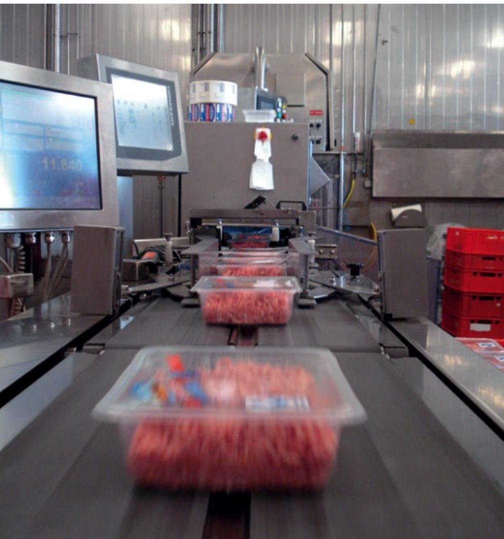
■ Abb. 3: CO<sub>2</sub>, N<sub>2</sub> und O<sub>2</sub> dienen in verschiedenen produktspezifischen Mischungen zur Verpackung unter Schutzatmosphäre (Modified Atmosphere Packaging, MAP).
