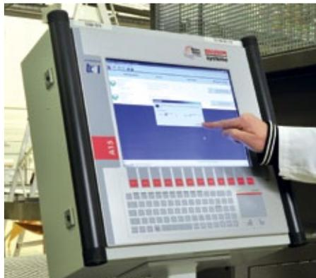
■ **Abb. 2:** Die Ansteuerung der Etikettendruckspender erfolgt über die auf den Industrie-PC (IPC) installierten Steuerungssoftware „bluhm ware.“
