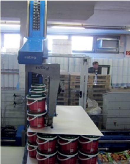
■ Abb. 3: Das Bild zeigt den Palettiervorgang eines Eimerstapels nach dem Legen der ersten Zwischenlage.
