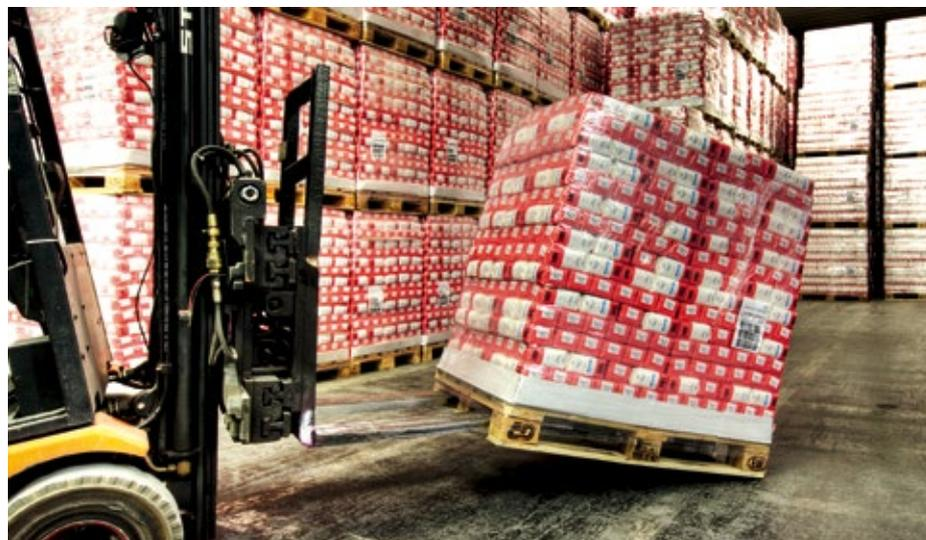
■ Abb. 1: Bessere Ladungssicherung auf den Straßen mit Antim65 Zwischenbogen, der die strenge Norm DIN EN 12195-1 erfüllt mit einem Rutschwinkel von mehr als 27 Grad.
