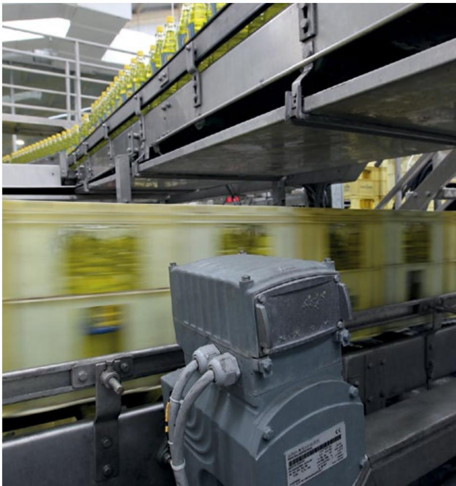
■ **Abb. 1:** Das mechatronische Antriebssystem Movigear vereinigt Synchronmotor, Getriebe und Frequenzumrichter als mechatronische Einheit in einem Gehäuse. Es wurde speziell für die horizontale Fördertechnik entwickelt und kommt bei zahlreichen Getränkeherstellern zum Einsatz.
