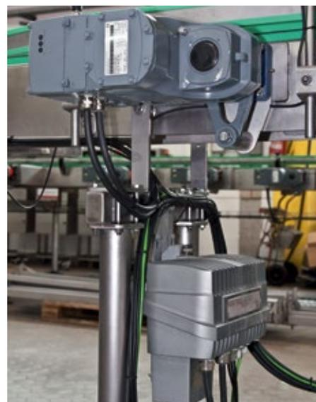
■ **Abb. 2:** Der Field-Device-Controller Movifit (unten im Bild) verbindet die mechatronischen Antriebseinheiten ins überlagerte Netzwerk. Beide Geräte sind im Hygienic Design ausgeführt.
