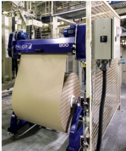
■ **Abb.2: Der Packroboter verliert keine Zwischenlagebogen mehr, weil jeweils nur ein Bogen abgeschnitten wird.**
