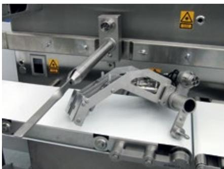
■ **Abb. 2:** Bei der Stückeschneidemaschine CUT 32 wird die Mehrfachkupplung von Eisele beim Montieren des Formateils automatisch angeschlossen.
