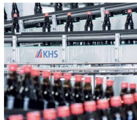
■ **Abb. 3:** Mit der Investition in das neue Rückkühler-/Pasteur-Konzept ging ein Austausch der Transporteure einher. Sie reduzieren die Lärmemission und steigern den Flaschendurchsatz innerhalb der Linie.
