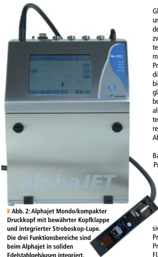
■ Abb. 2: Alphajet Mondo/kompakter Druckkopf mit bewährter Kopfklappe und integrierter Stroboskop-Lupe. Die drei Funktionsbereiche sind beim Alphajet in soliden Edelstahlgehäusen integriert.
