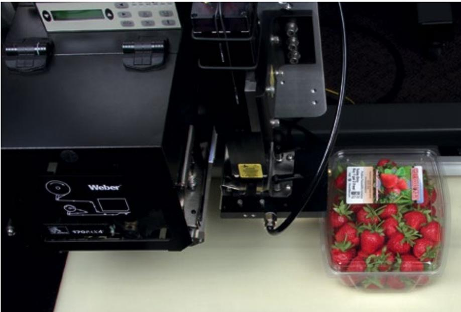
■ **Abb. 2:** Für das Aufbringen von Etiketten gibt es Etikettendruckspender mit unterschiedlichen Applikatoren.
