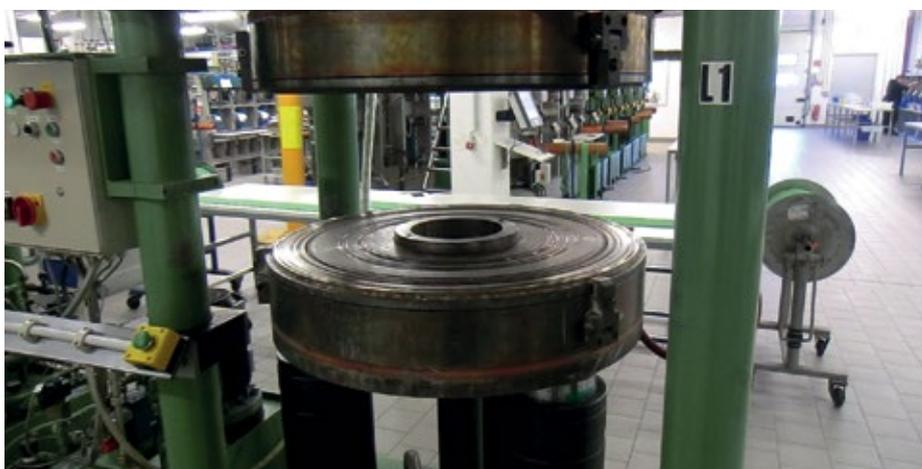
■ **Abb. 3:** Je nach Dichtungswerkstoff werden O-Ringe bei dreistelligen Temperaturen gepresst, z.B. bei 160-185 °C bei hochwertigem Fluor-Kautschuk. Der Gang durch die Produktion von COG ist für die Seminarteilnehmer ein besonderes Highlight der O-Ring-Akademie.
