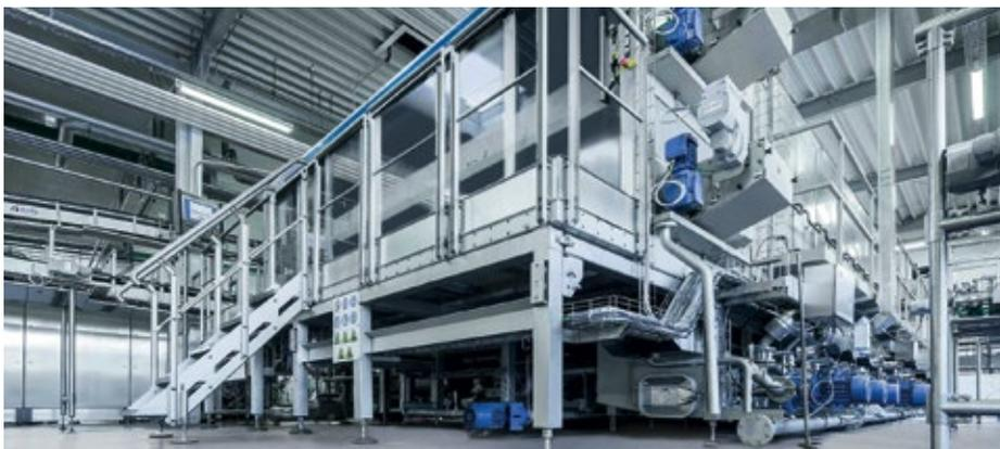
■ **Abb. 2:** Der Innopas PIISC wurde aus dem KHS-Baukastensystem ganz an den Anforderungen von Haus Rabenhorst orientiert zusammengestellt. Schon im Projektstadium simulierte KHS den Rückkühl- bzw. Pasteurisationsprozess für jedes einzelne Produkt in Verbindung mit der jeweils verwendeten Glasflasche und lieferte genaueste Berechnungen.
