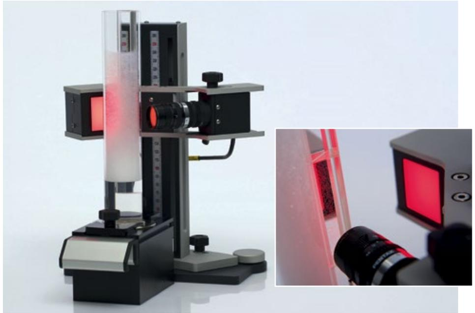
Produktbereich. Der Schwerpunkt dieses modularen Instruments lag zunächst auf Zerfallsmessungen instabiler Schäume. Eine 2012 vorgestellte Komponente zur Messung des Flüssigkeitsgehalts sowie das neue, optische Modul sind auf stabile und metastabile Schäume ausgerichtet.
