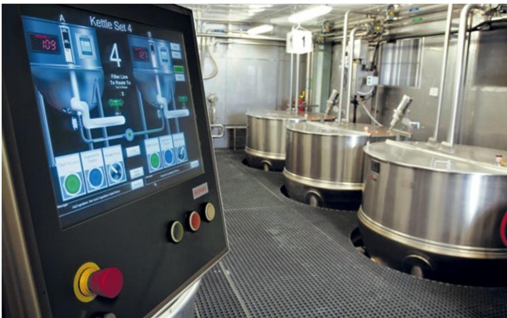
■ **Abb. 2:** Das Unternehmen nutzt Beckhoff-Edelstahl-Panel-PCs CP7702 mit 15-Zoll-Touchscreen im gesamten Werk. Die in Schutzart IP 65 ausgeführten Edelstahl-Panel zeichnen sich durch ihr spaltfreies Gehäusedesign mit flächenbündigem Touchpanel aus und sind auf Steuerungsaufgaben unter den strengen Hygieneanforderungen der Lebensmittelherstellung zugeschnitten.
