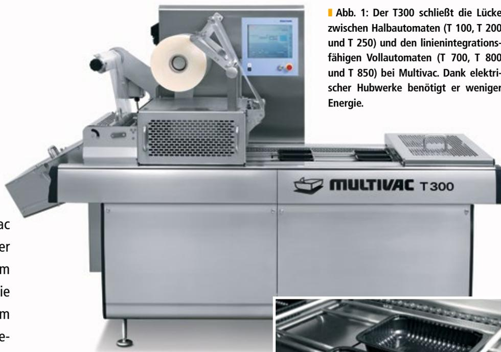
Abb. 1: Der T300 schließt die Lücke zwischen Halbautomaten (T 100, T 200 und T 250) und den linienintegrationsfähigen Vollautomaten (T 700, T 800 und T 850) bei Multivac. Dank elektrischer Hubwerke benötigt er weniger Energie.
