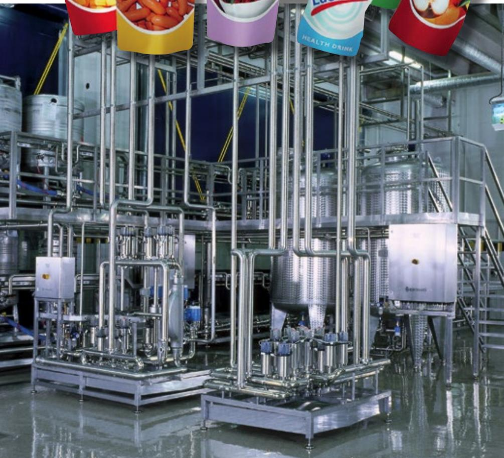
Abb. 1: Heute, rund 40 Jahre nach seiner Erstversion ist der Heidelberger Mixer zu einer Hochleistungs-Prozessanlage zum Ausmischen von Getränken aller Art gereift.
