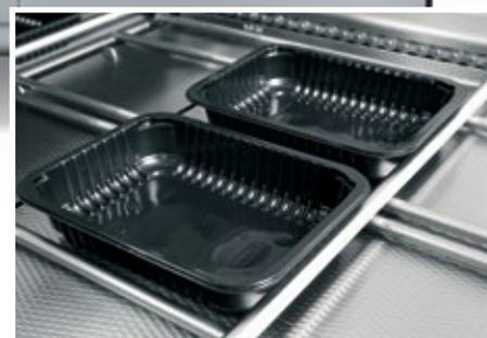
Abb. 2: Beim T 300 ist die Zuführung der Trays für alle gängigen Trayhöhen bis 110 mm und eine große Vielfalt von Trayformen möglich.
