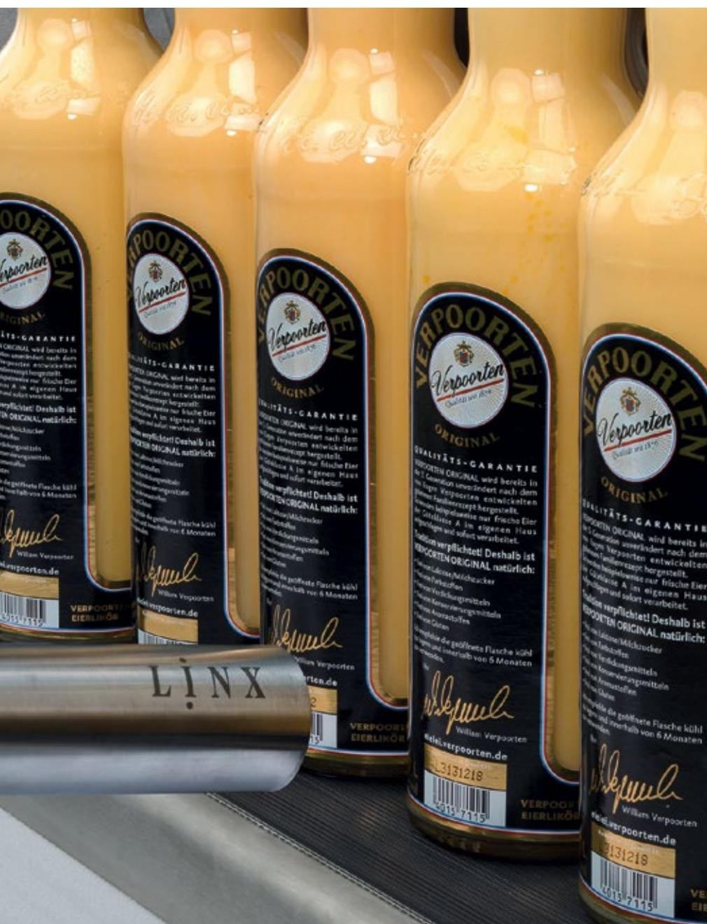
■ Abb. 1: Für die Flaschenbeschriftung kommt ein bedienerfreundlicher Linx Tintenstrahldrucker zum Einsatz.
