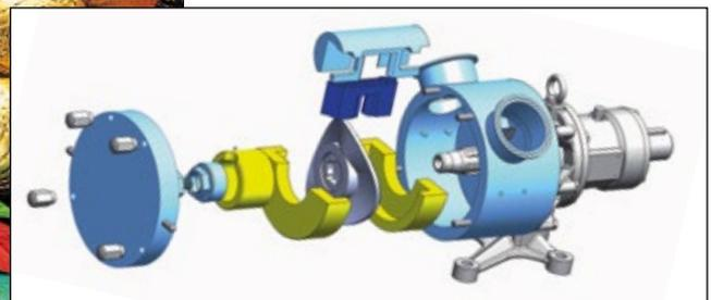
Abb. 2: Die sinusförmige Gestaltung des Rotors lässt bei der Drehung vier Kammern entstehen, durch die das Medium von der Einlassöffnung bis zur Auslassöffnung befördert wird. © Watson-Marlow
