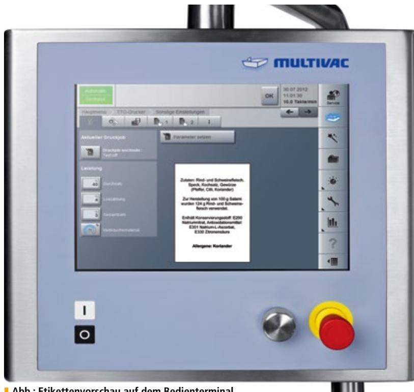
Abb.: Etikettenvorschau auf dem Bedienterminal.
