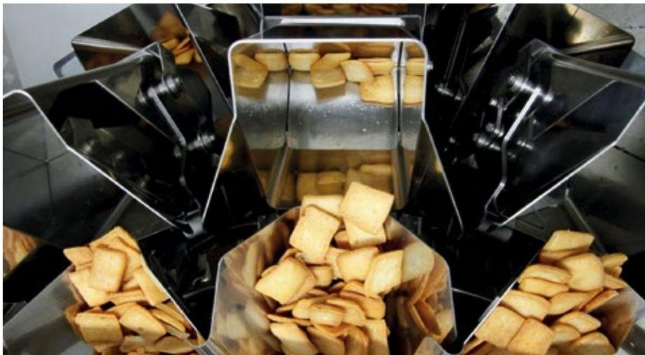
■ Abb. 1: Die Hochleistungs-Mehrkopfwaage CCW-R befüllt bis zu 260 Beutel pro Minute mit Brotsnacks. © Ishida
