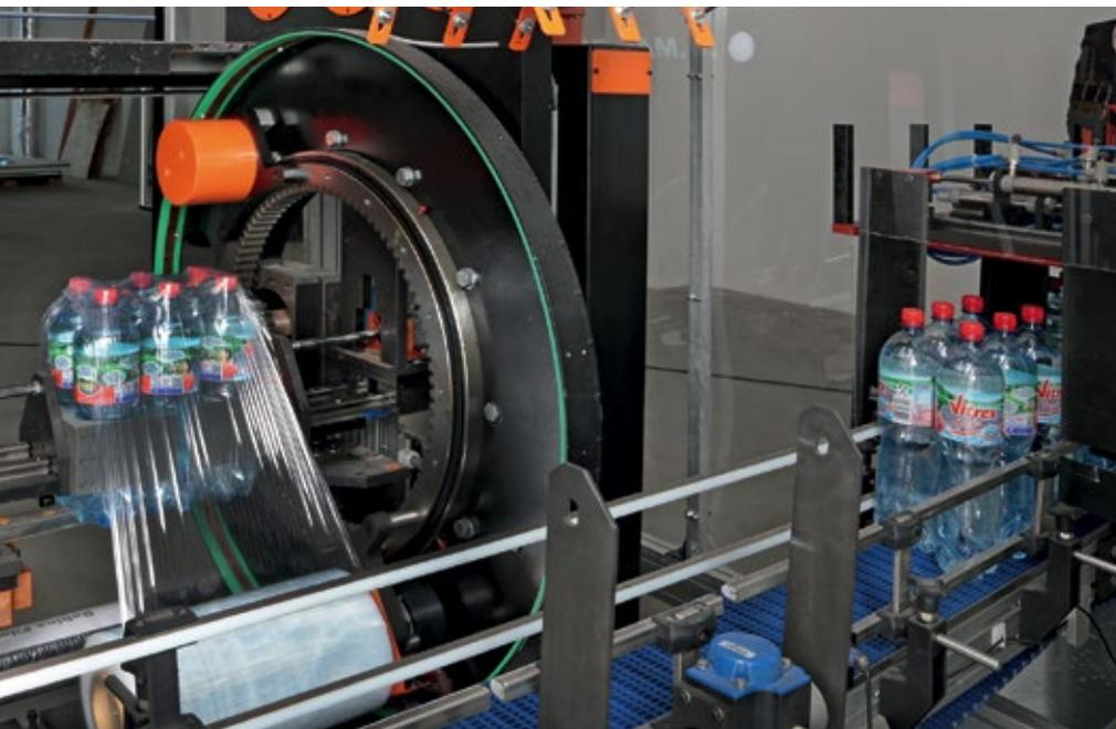
■ **Abb. 1: Cyclepacker: Innovation zur Herstellung von Gebindeverpackungen. Statt zu Schrumpfen, werden die PET-Gebinde mit der Hochleistungsfolie Twistex umwickelt.**
