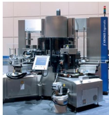
■ **Abb. 2: Energiesparer:** Moderne Etikettiermaschinen benötigen immer weniger Strom, denn sie verzichten auf energieaufwendige thermische Prozesse wie das Heißkleben. © Kronen
