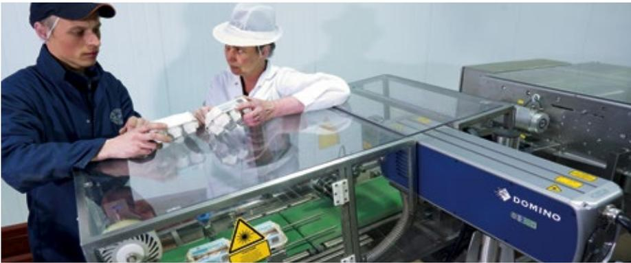
■ **Abb. 2:** Der energieeffiziente, kompakte und benutzerfreundliche D320i Laser-Codierer leistet die permanente Beschriftung unterschiedlichster Materialien bei niedrigen und hohen Geschwindigkeiten.
