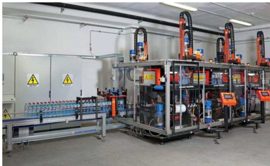
■ **Abb. 2: Modularer Aufbau des Wickelsystems Cyclepacker: Die Kapazität des Cyclepackers lässt sich mit jedem Modul um 6.000 Flaschen pro Stunde erweitern.** © Antalis Verpackungen GmbH
