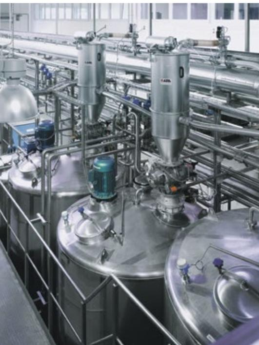
■ Abb. 2: Die Entgasungssilos werden pneumatisch beschickt.
