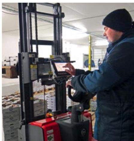
■ Abb. 2: Am Bildschirm wird angezeigt, in welchem Bereich der Pickzone die Palette mit dem bestellten Produkt zu finden ist. Dank CSB-System hat sich die Zeit für die Kommissionierung halbiert.
