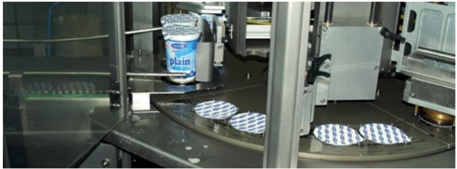
■ **Abb. 3:** Die befüllten und versiegelten Becher werden über eine Hubeinheit auf ein Förderband angehoben und sind versandfertig.
