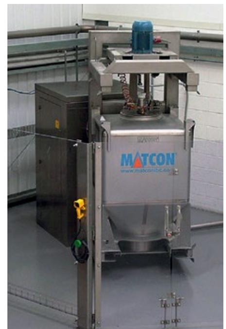
■ **Abb. 3:** Matcon-IBC-Mischer mit Sicherheitskäfig.
