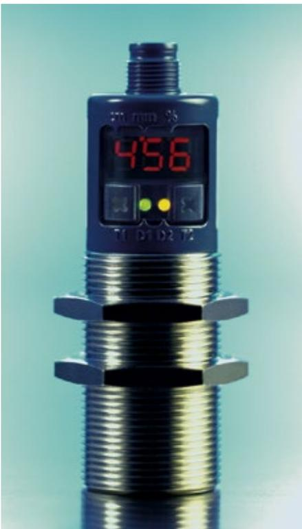
■ **Abb.2:** Die M30-Gewindehülse der Crm+ Ultraschallsensoren besteht aus rostfreiem Edelstahl und seine Membran ist durch eine PEEK-Folie geschützt, sodass die Reinigung der Abfüllanlage, Milchsäurebakterien und ausgehärtete Verschmutzungen den Sensoren nicht schaden können.
