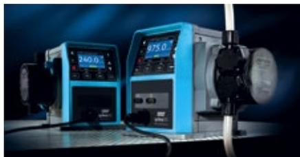
Die Watson-Marlow Pumps Group präsentiert die Qdos 60, das neueste Modell ihrer revolutionären, ventillosen Qdos-Dosierpumpenreihe. Die innovative und vielseitig einsetzbare Pumpe liefert Fördermengen von 0,1–1.000 ml/min bei einem Druck bis 7 bar. Durch ihre überlegene Dosiergenauigkeit spart sie Kosten bei der Dosierung von Chemikalien. Die innovative ReNu Pumpenkopf-Technologie ermöglicht eine einfache, werkzeugfreie Wartung und niedrigere
