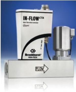
Mit der Einführung des Modells T23 baut Bronkhorst High-Tech seine Modellreihe In-Flowcta – Massedurchflussmesser und -regler für die industrielle Anwendung – weiter aus. Die Geräte arbeiten auf Basis der direkten Durchflussmessung (ohne Bypass) nach dem Konstanttemperatur-Anemometer-Prinzip. Sie enthalten keine beweglichen Teile. Die Gase strömen ohne Abzweigungen direkt
