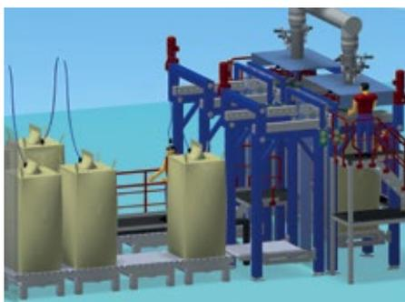
Abb. 3: Post-Gassing von Big-Bags nach der Abfüllung.
