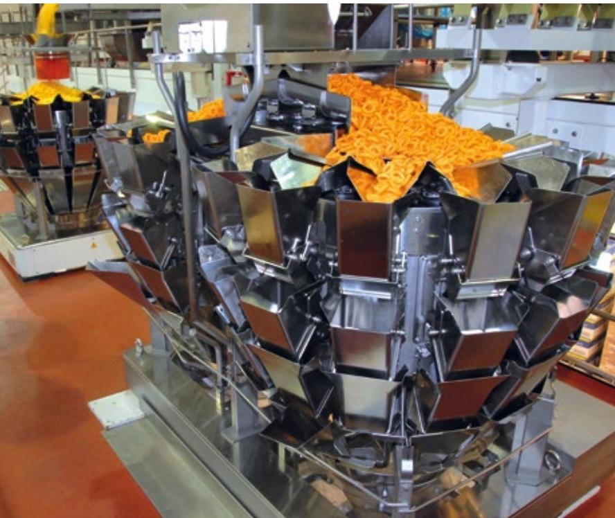
■ Abb. 1: Die nierenförmige Mehrkopfwaage CCW-R ist zweigeteilt, beide Hälften beschicken jeweils eine Schlauchbeutelmaschine.
