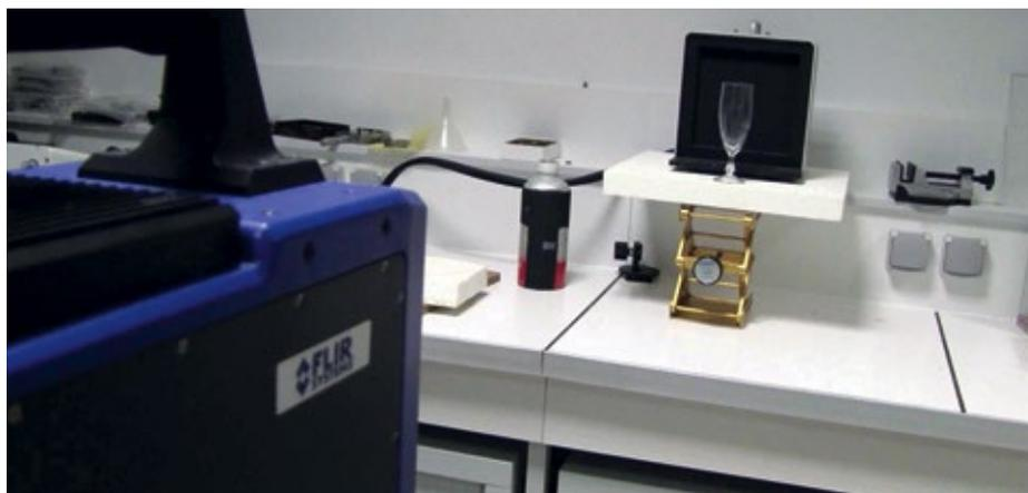
■ Abb. 2: Die SC7000 arbeitet in einem Wellenlängenbereich von 3 bis 5 µm, die der externe Filter auf eine Bandbreite um 4,245 µm einschränkt.
