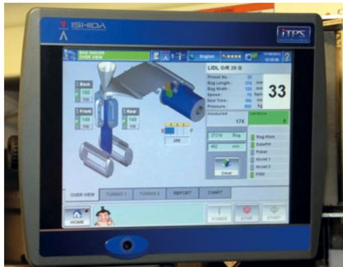
■ Abb. 3: Das komplette Verpackungssystem ITPS wird an einem Touchscreen bedient.
