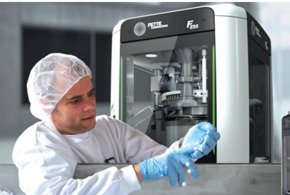
■ **Abb. 1:** Die Firma Sanotact verarbeitet mit der FE55 Pulvergemische zu Zwei-Schichttabletten. Thomas Breuer, Leiter des Pressraums, prüft die Qualität der Tabletten.
