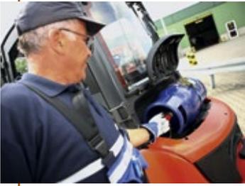
Das Wechseln von Treibgasflaschen kostete Staplerfahrer bislang jede Menge Zeit und Geduld. Die neue Click-on-Treibgasflasche von Westfalengas, Conneo, zeichnet sich aus durch einen schnell zu montierenden Adapter, der zu allen handelsüblichen Staplern passt und in Sekundenschnelle auf das kompakte und griffige Flaschenventil mit senkrechtem Anschluss gesteckt wird. Das System wurde vier Monate auf
