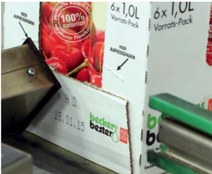
■ Abb. 2: Für die Großschriftbedruckung der Kartons kommen Markoprint-Drucker mit Trident-Tintentechnologie zum Einsatz.
