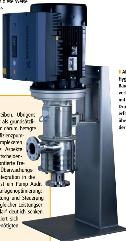
■ **Abb. 2: Mehrstufige Hygiene-Pumpe der Baureihe Contra in vertikaler Aufstellung mit exzentrischem Druckstutzen; dabei erfolgt das Entleeren über die Saugseite der Pumpe.**
