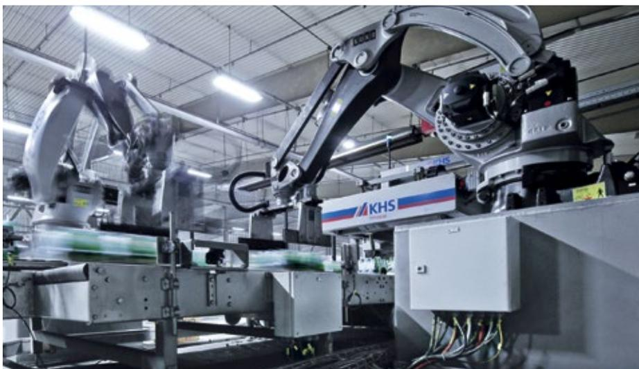
■ Abb. 2: Die Palettierung von gebildeten Tray-Shrink-Verpackungen geschieht mit dem Hochleistungs-Palettierer Innopal PB1HS, dem die Inline-Roboter-Gruppierstation mit zwei Robotern direkt vorgeschaltet ist.
