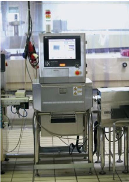
■ **Abb. 2:** Das Röntgenprüfsystem Ishida IX-GA-2475 findet Fremdkörper aus z. B. Metall, Glas, Stein oder Kunststoff.
