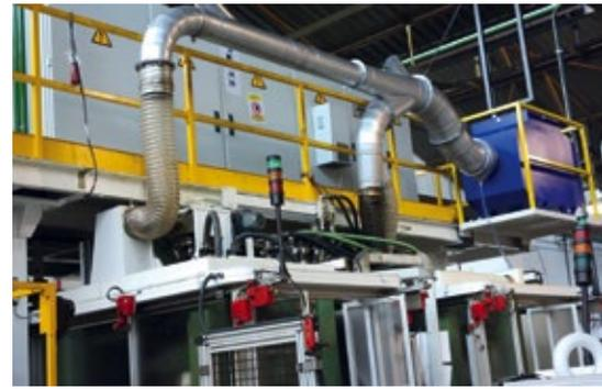
baren Kanalabscheider einmal jährlich einer Grundreinigung zu unterziehen. Die Vorabscheidung hält den Abluftkanal weitgehend ölfrei, die Abscheider sind zudem auch flammendurchschlagsfest. Diese Eigenschaft wird durch ein entsprechendes DIN- oder UL-Prüfzeichen nachgewiesen.
