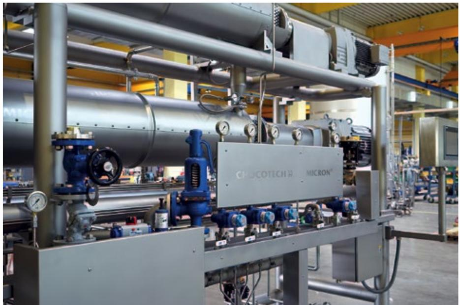
■ Abb. 2: Mit der Tabliermaschine Micron kann Zucker-, Frucht- und Milchfondant hergestellt werden. Abhängig vom Maschinentyp und der Rezeptur hat sie Durchsätze von 300 bis 1.500 kg/h.
