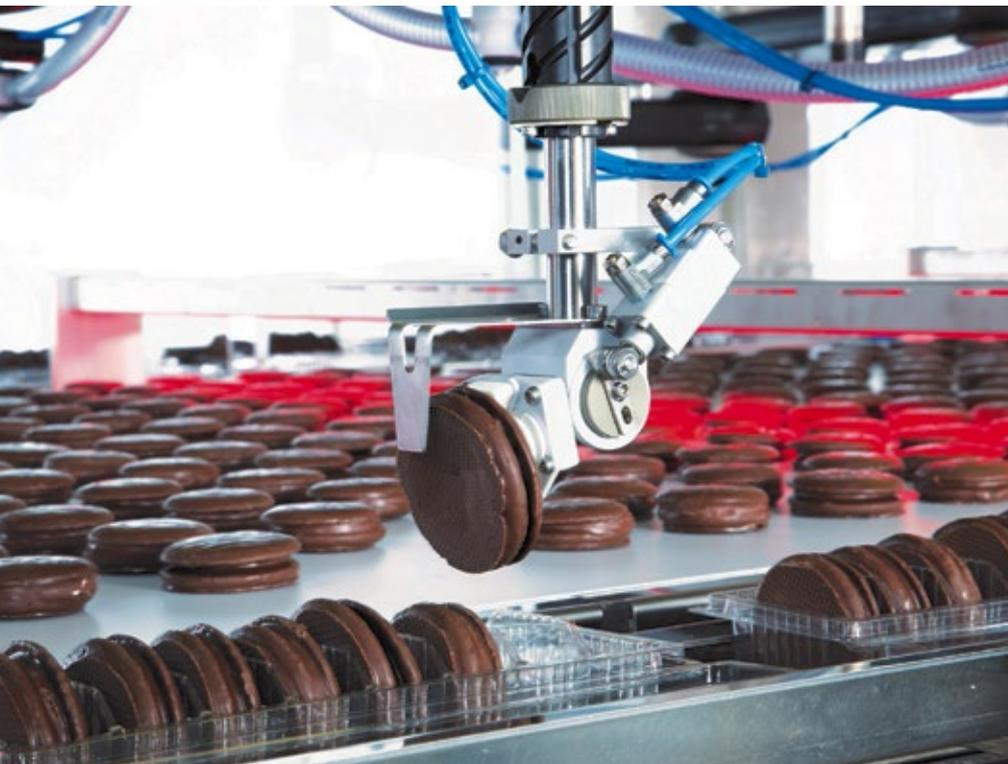
■ Abb. 2: Die F44-Roboter nehmen die Produkte vom Band auf, schwenken sie hochkant und setzen sie senkrecht in die Clamshells ein. Durch gleichzeitiges Saugen und Greifen ist die Handhabung der Kekse durch die von Schubert entwickelten Spezialwerkzeuge besonders produktschonend.
