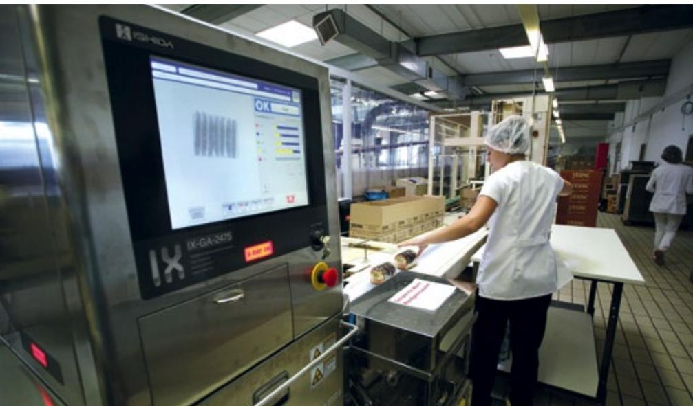
■ Abb. 1: Getestet und für gut befunden. Die Lebkuchen haben das Röntgenprüfsystem durchlaufen und gelangen zur Endverpackung.
