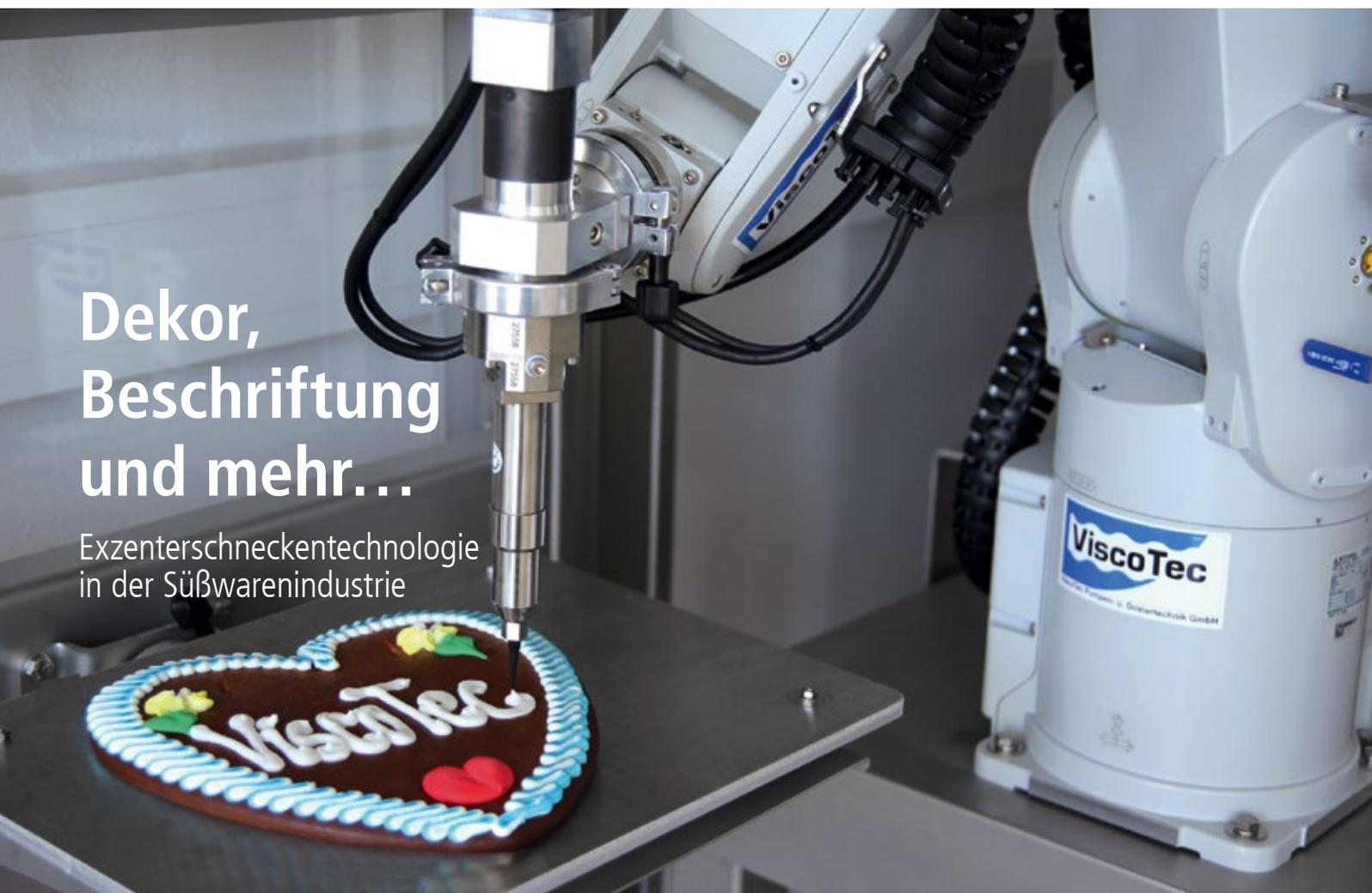
■ Abb. 1: Ein automatisierter Schriftzug für das Lebkuchenherz wird mit Exzentrerschneckentechnologie möglich...
