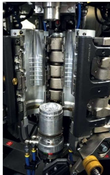
■ **Abb. 7:** Formelement für die PET-Flaschen in der Streckblasmaschine.
