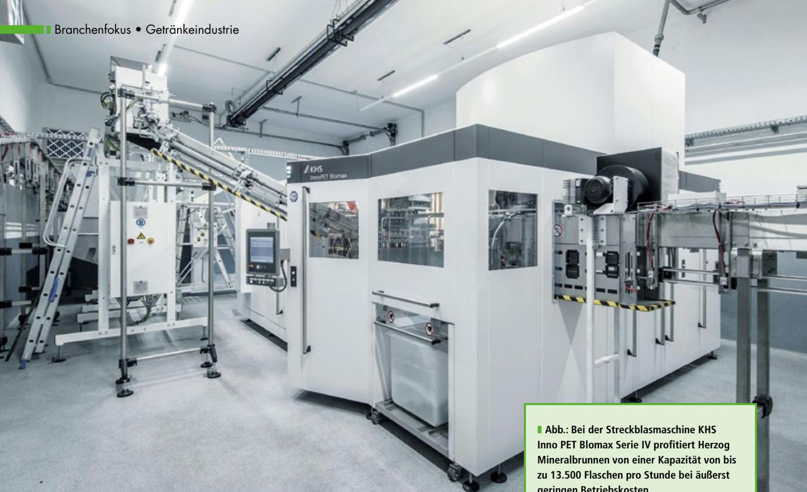
■ Abb.: Bei der Streckblasmaschine KHS Inno PET Blomax Serie IV profitiert Herzog Mineralbrunnen von einer Kapazität von bis zu 13.500 Flaschen pro Stunde bei äußerst geringen Betriebskosten.
