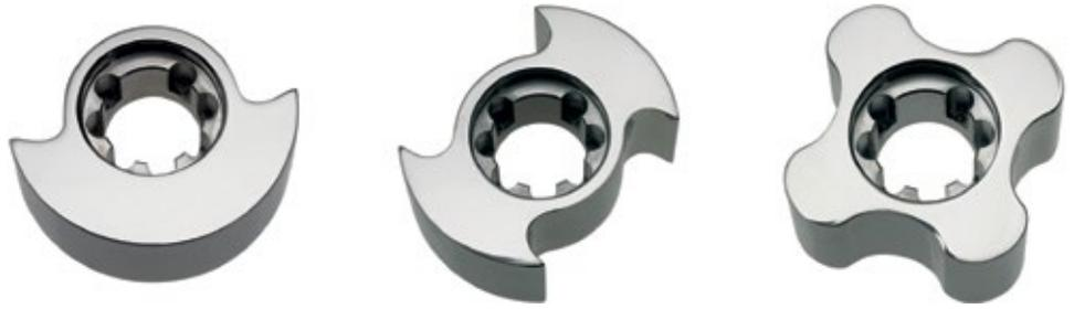
■ **Abb. 3:** Beispiel für Variationsvielfalt: Bei der Serie GEA Hilge Novalobe sind drei unterschiedliche Drehkolbengeometrien verfügbar, so dass auch teigige oder sehr scherempfindliche Medien schonend befördert werden können.
