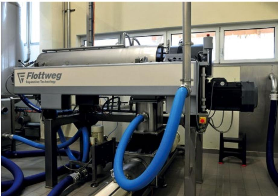
■ Abb. 2: Die moderne Trenntechnik der Firma Flottweg ermöglicht das Abscheiden unerwünschter Bitterstoffe der Lupinen-Pflanze.
