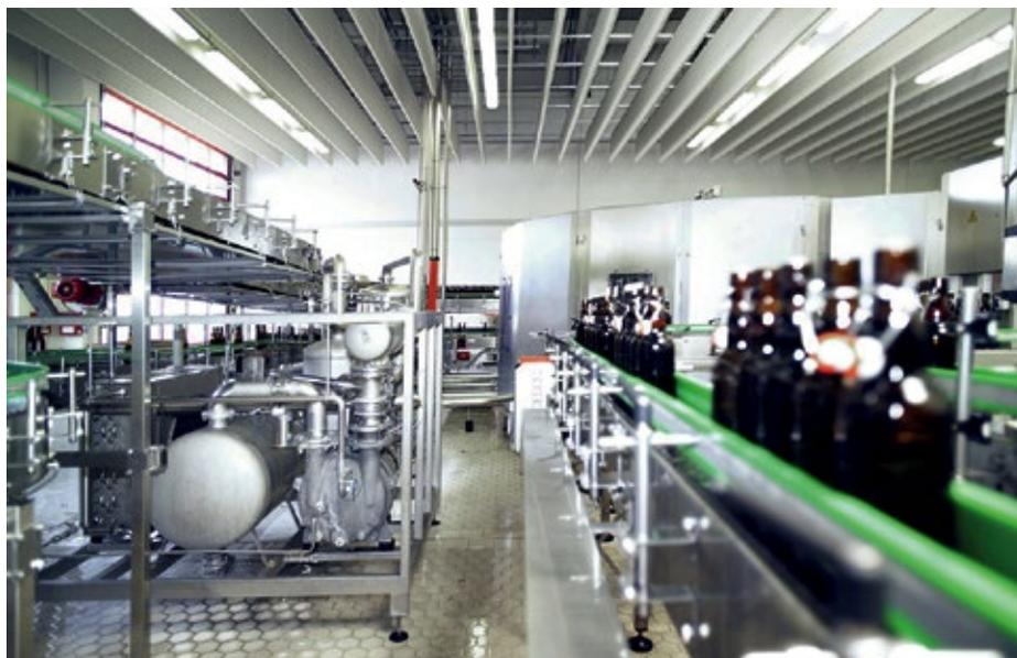
■ **Abb. 3:** Wassersparende Vakuumtechnik in der Getränkeabfüllung mit L-BL2-Aggregat.
