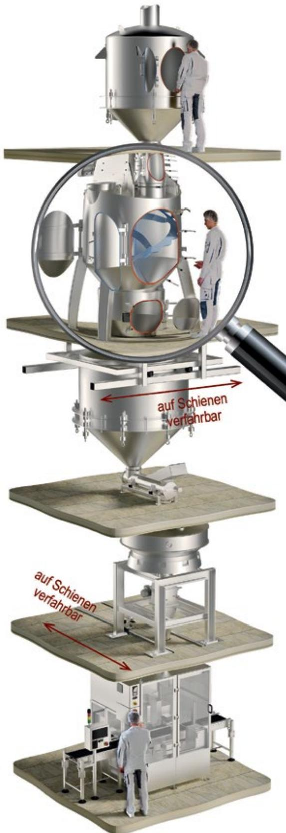
■ Abb. 1.: Beispiel einer End-of-the-Line-Mischanlage für variable Chargengrößen von 300 bis 2.000 l.
