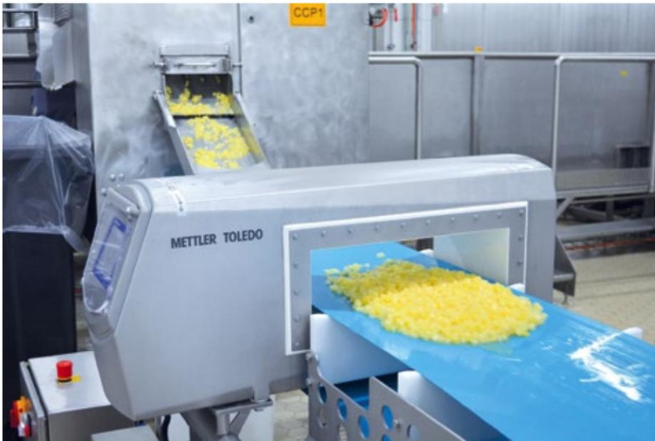
■ Abb. 2: Das Metallsuchsystem Profile Advantage wurde speziell zur Inspektion von feuchten – und damit leitfähigen – Produkten wie beispielsweise Ananas entwickelt.
