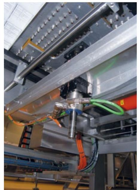
■ Abb. 2: Ein tubularer Linearmotor von Linmot mit Dreiphasenwicklung sorgt in der neuen Gießmaschine für ein präzises, dynamisches, geregeltes und gleichzeitig sanftes Anheben der Formen.
