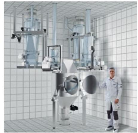
■ **Abb. 3:** Der Amixon Kontinuierlich-Mischer mit vier gravimetrisch arbeitenden Dosiersystemen. Der Mischer ruht auf Wägezellen. Einfüllstutzen und Austragsstutzen sind mit flexiblen Man-schetten versehen. Die Verschlussarmatur des Mixers wird so gesteuert, dass der Füllgrad im Mischer konstant bleibt. Dieser Präzisionsmischer kann auch chargenweise genutzt werden.
