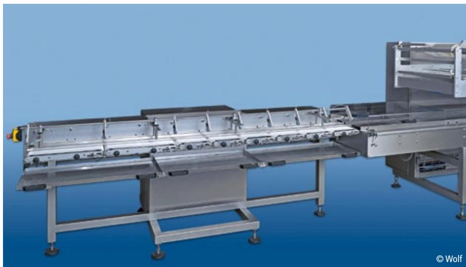
■ **Abb. 2:** Die Zuführeinheit der Verpackungsmaschine HV 200. In kontinuierlicher Arbeitsweise kann sie – je nach Hüllstoff – 200 bzw. 250 Beutel in der Minute abfüllen.
