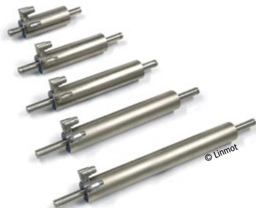
■ Abb. 3: Die Linearmotoren aus der Serie P10-70 sind mit Spitzenkräften bis zu 2.500 N die leistungsstärksten Motoren aus dem Linmot-Programm. Dank ihrer modularen Bauweise lassen sich Hübe zwischen 10 und 1.770 mm implementieren.
