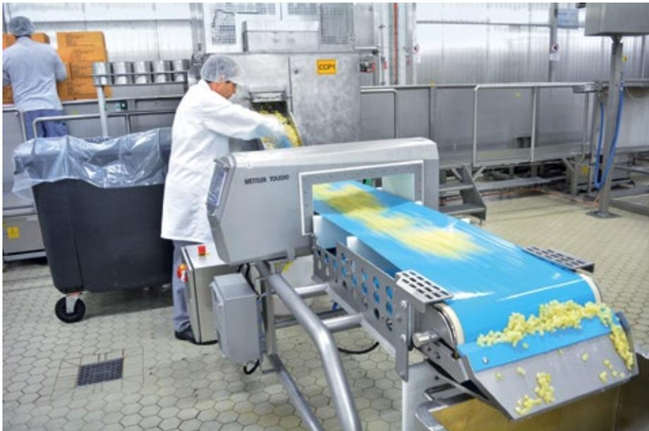
■ Abb. 3: Erkennt das Metallsuchsystem einen Fremdkörper, wird er durch Bandreversierung aus der Linie entfernt. Um unnötigen Produktverlust zu vermeiden, stoppt währenddessen die Produktzufuhr der Dosenöffnungsanlage.
