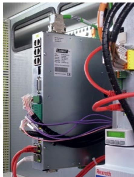
■ Abb. 4: Der Regler E1400 mit direkter Netzeinspeisung versorgt den Linearmotor P10-70 mit ausreichend Energie. Für die Anbindung an die Bewegungssteuerung stehen diverse Schnittstellen wie Sercos III (im Bild), Profinet oder Powerlink zur Verfügung.
