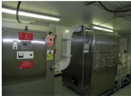
■ Abb. 3: Die Enremilk-Testanlage zur Mikrowellen-Pasteurisierung.
