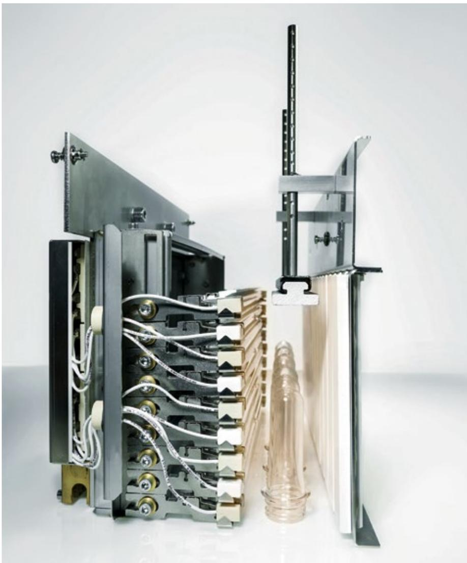
■ Abb.: Neue Reflektoren aus moderner Keramik und eine präzise angepasste Geometrie zeichnen die Heizkästen aus.
