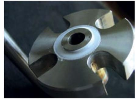
Ventilblöcke des E-Programms wahlweise mit PTFE- und mit Graphitdichtungen an. Erstere sind beim Einsatz unter hohen Temperaturen deutlich im Nachteil, erklärt Häffner: Anders verhält es sich mit Graphit: Der Kohlenstoff weist auch bei extremen Temperaturen keine nennenswerte Verformung auf und sorgt für eine dauerhaft leckagefreie Flanschverbindung.
