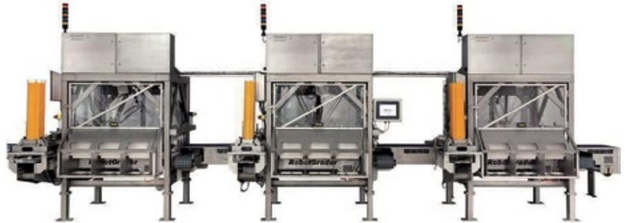
und die Arbeitskosten reduzieren sich typischerweise um 70%. Je nach Ausführung kann das Verpackungssystem gleichzeitig bis zu vier Schalenarten und bis zu drei Zielgewichte verarbeiten. Produktstücke mit ungeeignetem
