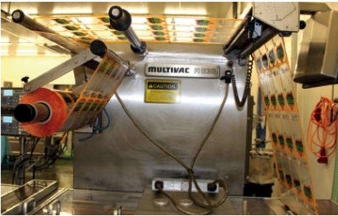
■ Abb. 2: Die Aufgabe war die effiziente Integration der KBA-Metronic Thermotransferdrucker in die Produktion mit Multivac Tiefziehmaschinen, bestückt mit MR-Queretikettierern.
