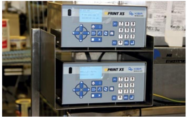
■ Abb. 3: Die Trennung von Steuerteil und Druckwerk des Ttprint ermöglicht platz- und gewichtsparende Befestigung an der Verpackungsanlage.
