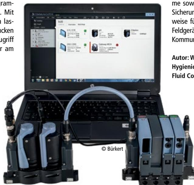
Abb. 3: Das auf Windows basierende Programm dient der Konfiguration bzw. Parametrierung aller „intelligenten“ Bürkert-Produkte mit elektrischen Komponenten und kann auf der Internetseite des Unternehmens kostenfrei bezogen werden.
