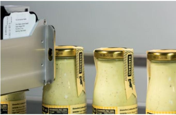
■ **Abb. 2:** Dank der neuen HP-Tinte können nun auch Anwendungen mit thermischem Inkjet-Verfahren gelöst werden, für die bisher nur das Continuous Inkjet-Verfahren in Frage kam: das abriebfeste Beschriften von glatten Materialien.
