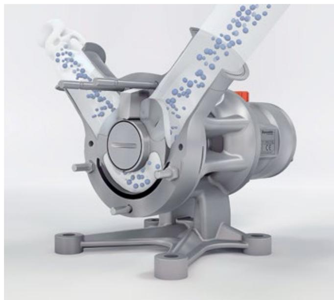
■ **Abb. 4:** Da die Kammern der Sinuspumpe im Ganzen verschoben werden, wird das Medium besonders schonend von der Einlass- bis zur Auslassöffnung befördert.
