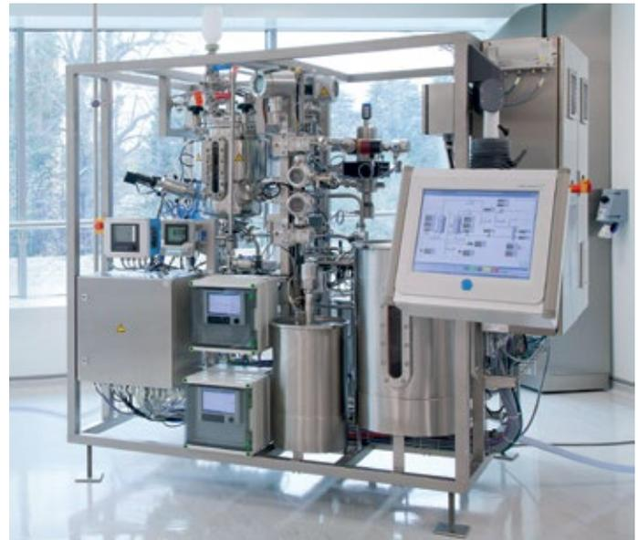
■ **Abb. 3:** Bei der Chromatographie sorgt die Überwachung mit pH-Sensoren und dem UV-Prozessphotometer OUSAF44 für optimale Produktausbeute.
