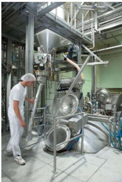
Mitarbeiter dosieren gleichzeitig auf der einen Seite Zucker ein und auf der anderen Seite die Früchte. Das verdrängte Luftvolumen wird abgesaugt und zunächst durch einen Nassabscheider geführt und dann durch einen Entstauber mit Aktivkohlefilter. Hier kommt ein Ruwac-Industriesauger vom Typ DA 1.300 für Staub-Ex-Zone 22 zum Einsatz, der stationär montiert und nicht – wie sonst üblich – mobil unterwegs ist. Auch der Nassabscheider NA
