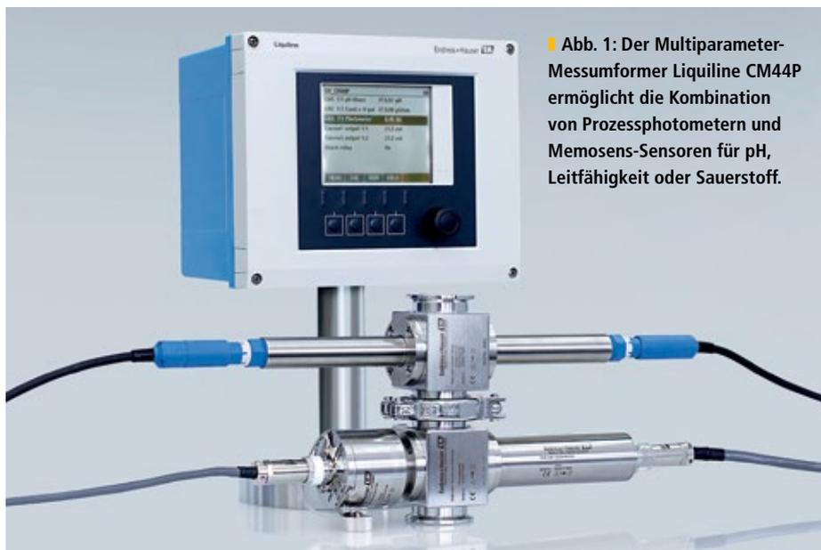
**Abb. 1: Der Multiparameter-Messumformer Liquiline CM44P ermöglicht die Kombination von Prozessphotometern und Memosens-Sensoren für pH, Leitfähigkeit oder Sauerstoff.**
