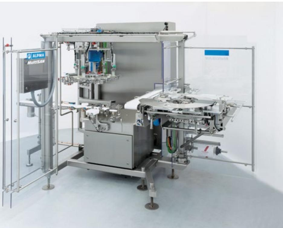
■ Abb. 2: Durch den Einsatz von Direktantriebstechnik konnte die Multisan mechanisch so entkoppelt werden, dass sensible Komponenten aus dem Schaumreinigungsbereich weggeklappt werden können. Gleichzeitig erleichtert diese Reinigungsstellung im Wartungsfall den Zugang zur Maschine.
