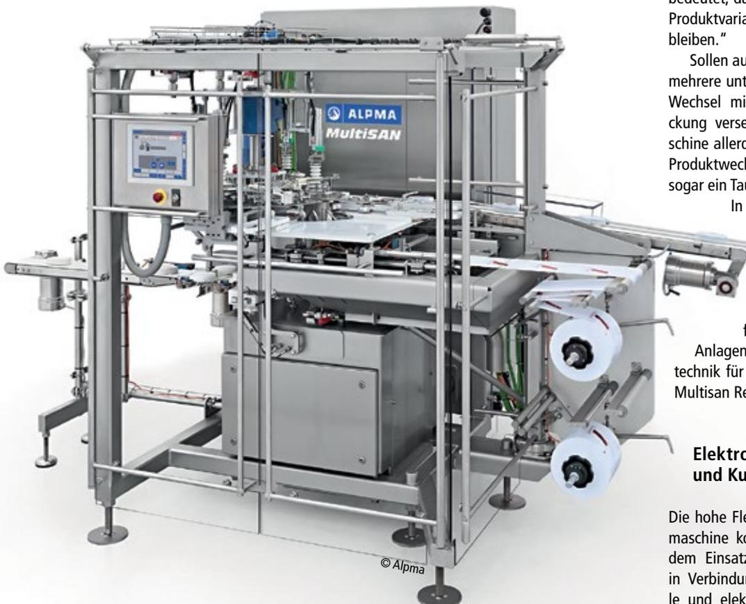
■ Abb. 1: Die neue Folieneinschlagmaschine von Alpma kann dank der eingesetzten Linearmotoren von Linmot wesentlich mehr unterschiedliche Produkte ohne Umbauten verarbeiten.
