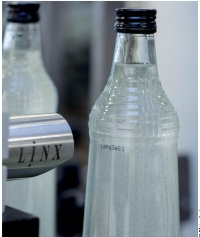
■ Abb. 2: Ein Linx-Drucker bringt Chargennummern und verschlüsselte Produktionsdaten direkt auf die Glasflasche auf.
