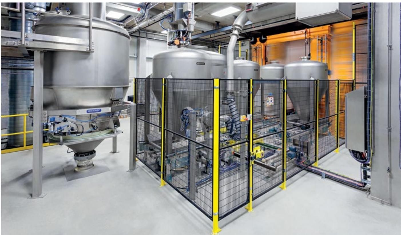
■ **Abb. 3:** Vollautomatische Mischerbeschickung durch Saugwagen (Aussensilos) und ein dreidimensionales Container Transportsystem.
