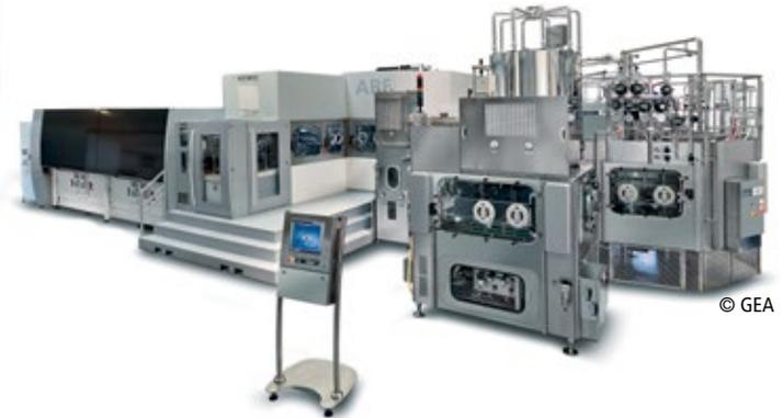
■ Abb. 1: Die Aseptic Blow Fill (ABF) Lösung von GEA mit H2O2-Sterilisierung für Verschlüsse aus Alufolie, geeignet für Getränke mit niedrigem und hohem Säuregehalt ist ein sicheres, flexibles und aseptisches Verfahren zur Befüllung von Kunststoffflaschen. Das neue System GEA Sterilfoil VHP L wurde für die Foliensterilisation entwickelt.
