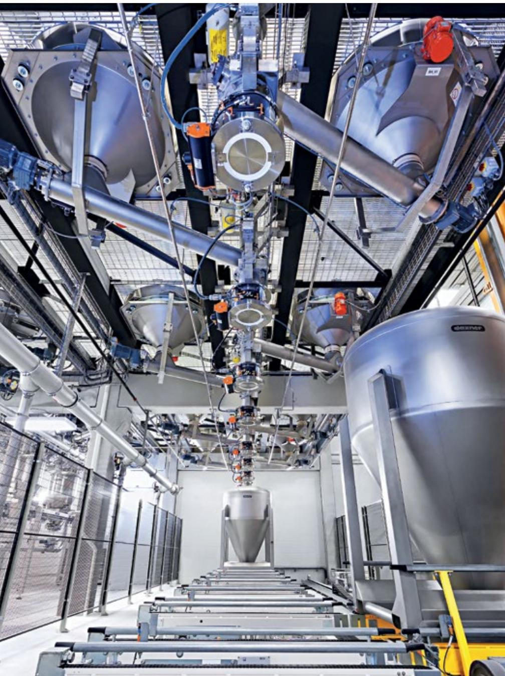
■ Abb. 1: Vollautomatisches, dreidimensionales Containertransportsystem zum Absammeln von Mittel- und Kleinkomponenten.
