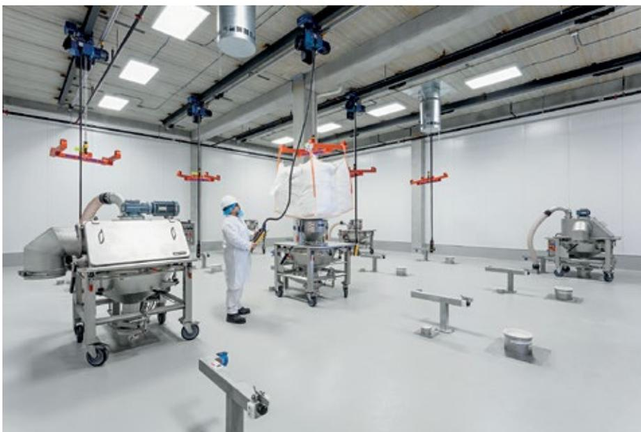
■ **Abb. 2:** Mittelkomponenten werden in Tagessilos gelagert und mittels mobilen Aufgabestationen mit integrierten Kontrollsiebmaschinen befüllt.
