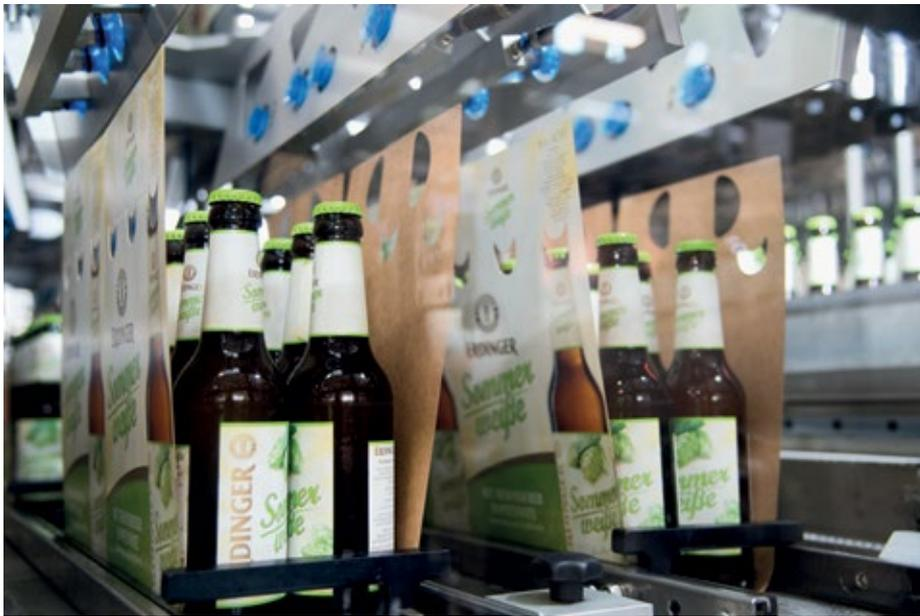
■ **Abb. 3:** Die Varioline 4M überzeugt durch ihre Fähigkeit, sowohl Einweg- als auch Mehrweggebilde zu verarbeiten. Dies resultiert für den Endkunden in erhöhter Flexibilität im Verpackungsprozess.
