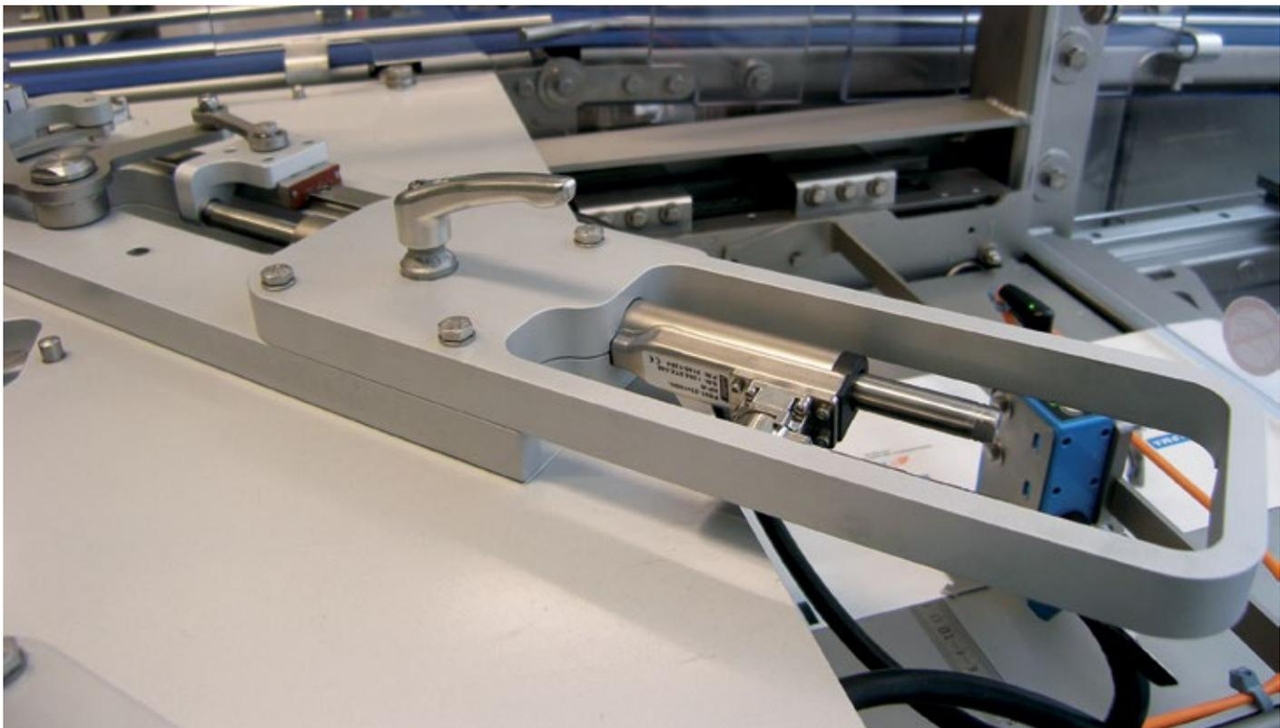
■ Alpma hat die Linmot-Motoren mit der Verschleißmechanik zu einem Modul geformt, das mehrmals in der Maschine Verwendung findet und so konstruiert ist, dass es gleichzeitig als Kühlkörper für die Linearmotoren fungiert. Die Verschleißmodule der Multisan lassen sich mit wenigen Handgriffen versetzen und so eine Formatumstellung in ein paar Minuten erledigen.
