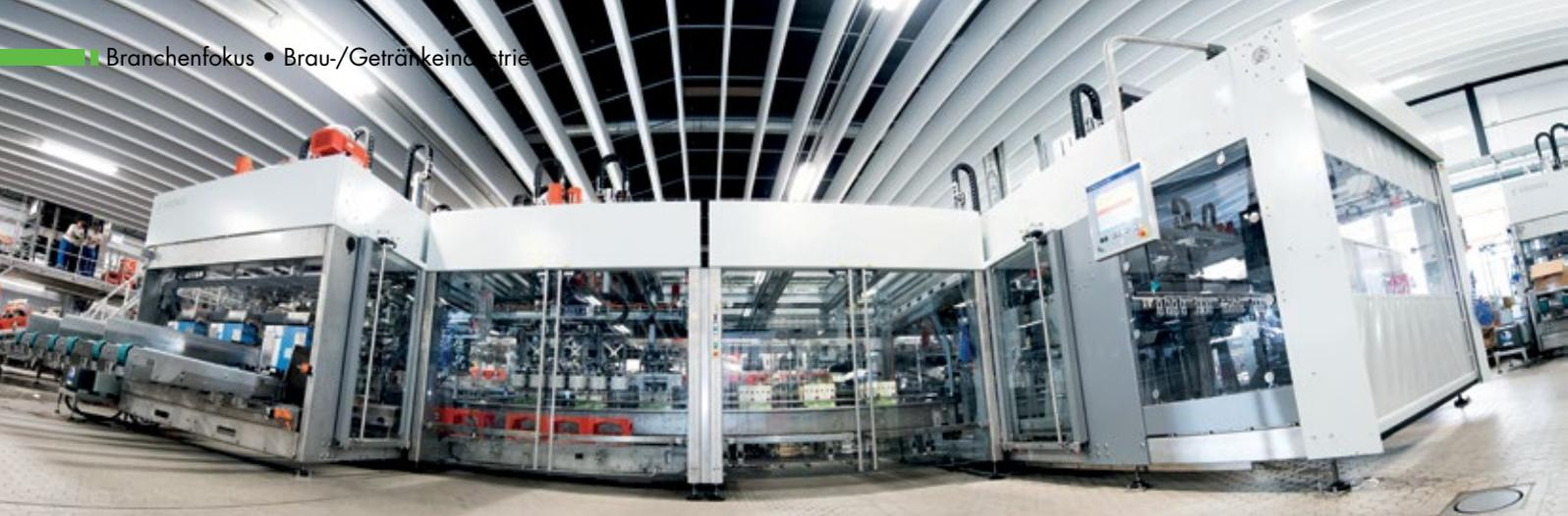
■ **Abb. 1:** Um individuelle Kundenwünsche im Bereich der Endverpackung abzubilden, wird die Krones Varioline aus einem ausgeklügelten Baukastensystem geplant, konstruiert und hergestellt.
