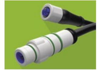
Gleich- und Wechselstrom wird verwendet um Geräte sicher mit hoher Leistung zu versorgen, etwa für Linearantriebe und Schrittmotoren oder als Powerzuleitung für Feldbusmodule. Dichtungen aus FKM sowie eine Umspritzung aus PUR ermöglichen den Einsatz in allen industriellen Applikationen bis zu Schutzart IP67. Eine Verschraubung aus vernickeltem Zinkdruckguss sichert die Steckverbindung gegen unbeabsichtigtes Lösen.
