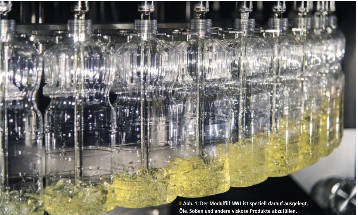
■ Abb. 1: Der Modulfill NWJ ist speziell darauf ausgelegt, Öle, Soßen und andere viskose Produkte abzufüllen.
