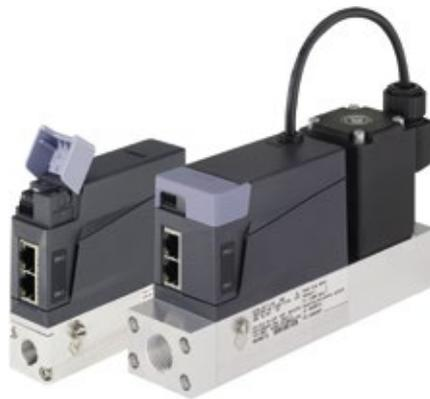
20-2.500 IN/min ab. Die medienberührenden Teile sind aus Edelstahl gefertigt, um eine Fermentkontamination auszuschließen. Die Massendurchflussregler sind daher konform zu den Zulassungen USP Class VI, FDA, 3.1 Zeugnis und EG 1935. Durch direktmessende Sensoren sind die wiederholgenauen MFCs auch für kleinste Gasmengen geeignet. In Verbindung mit dem integrierten, direktwirkenden
