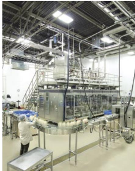
■ **Abb. 3:** Seit Mitte 2018 werden auf einer weiteren KHS-Aseptik-Linie, die für bis zu 12.000 1-Liter-Flaschen pro Stunde ausgelegt ist, auch kleinere Chargen produziert.
