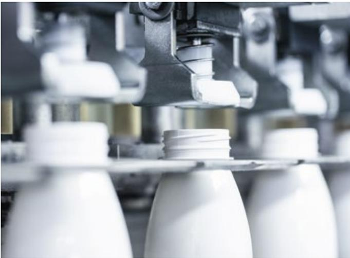
■ **Abb. 2:** Der Verschluss wird vollautomatisch auf die Flasche geschraubt. Zuvor wurde er mit Wasserstoffperoxid desinfiziert.
