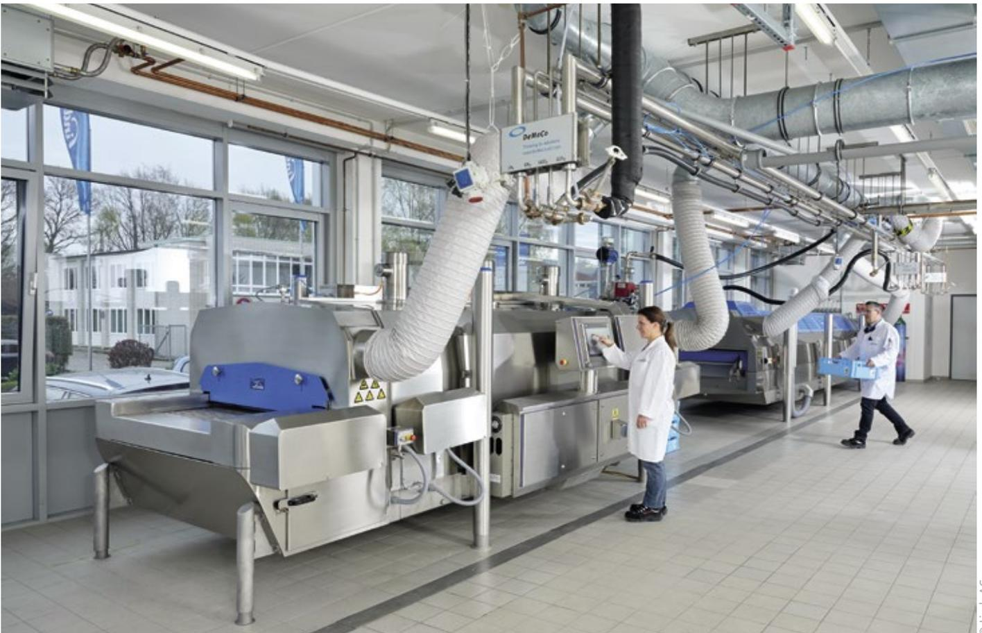
Abb. 1: Das ATZ bietet ideale Bedingungen für vergleichende Praxistests auf verschiedenen Maschinen, darunter mehrere kryogene Tunnel-, Pellet- und Schrankfroster.
