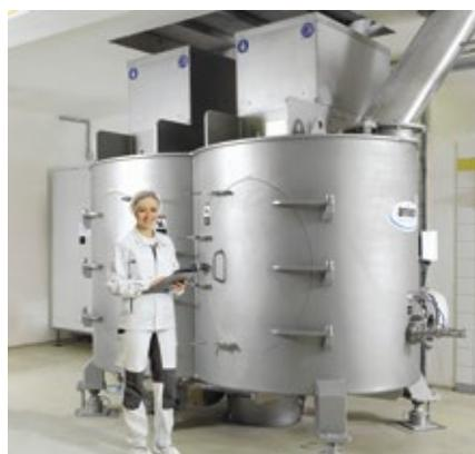
sive Querverströmung des auf- und abwärts fließenden Produkts. Dabei findet eine dreidimensionale Zufallsverteilung statt. Diese ist unabhängig vom Füllgrad, der Drehfrequenz und etwaig differenzierenden Komponenteneigenschaften wie Partikelgröße, Dichte, Kohäsion, Adhäsion oder Viskosität. Bei besonders fra-
