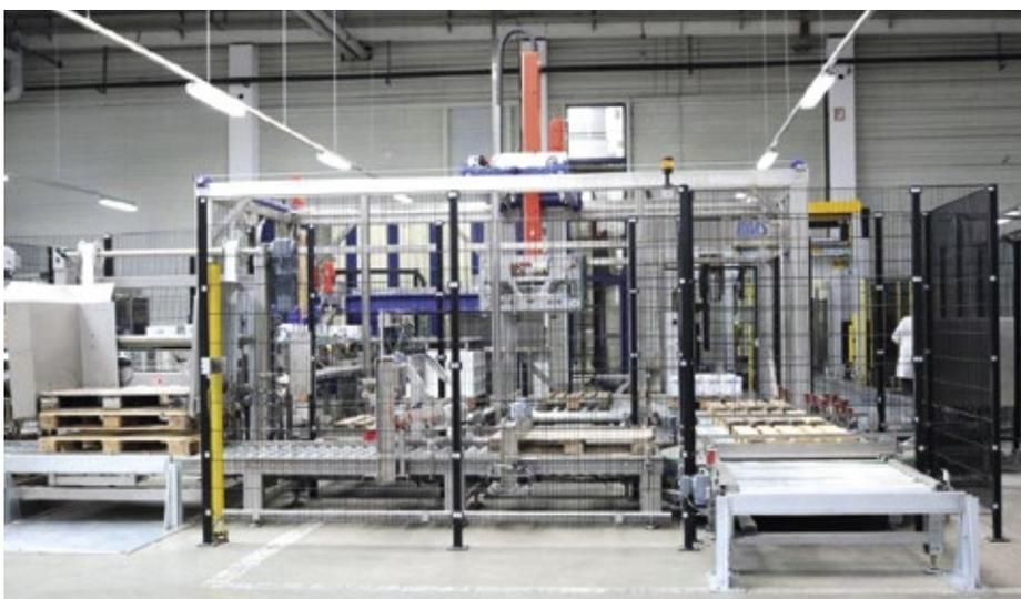
■ Abb. 3: Die spezifizizierte Leistung der Portal-Anlage bezogen auf die Europalette beträgt 57 Lagen pro Stunde und Linie. Insgesamt sind bei drei Linien damit 171 Lagen pro Stunde möglich.
