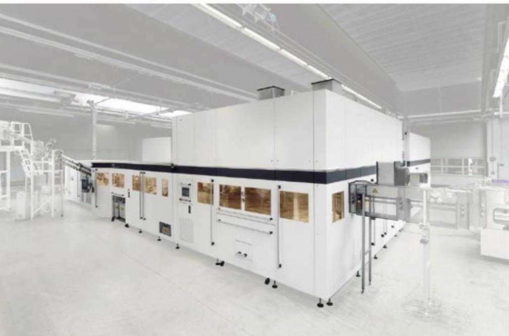
■ **Abb.:** Mit dem Plasma-Beschichtungsverfahren Freshsafe-PET bietet KHS die derzeit einzige anerkannte voll recycelbare Barriereköslung, um Recyclingquoten von PET-Getrönkeverpackungen mit erweitertem Produktschutz global zu erhöhen.
