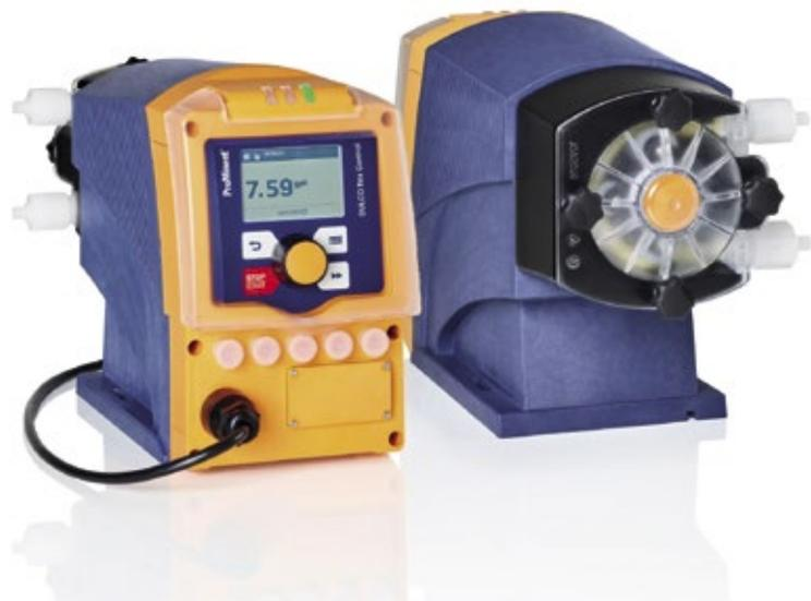
werden. Dadurch agiert sie noch smarter. Das vom Unternehmen entwickelte, einzigartige Schlauchwechselsystem ermöglicht einen schnellen und unkomplizierten Schlauchtausch ganz ohne Werkzeug. Das Display gibt dem Werker beim Schlauchwechsel genaue Anweisungen der zu absolvierenden Schritte. Der verwendete Hochleistungsschlauch aus thermoplastischem Elastomer gewährleistet hervorragende Chemikalienbeständigkeit
