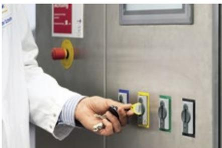
■ Abb. 3: Über den programmierten EKS-Chip wird die Ware ausschließlich an der richtigen Annahmestation und im richtigen Zielbehälter abgeladen.
