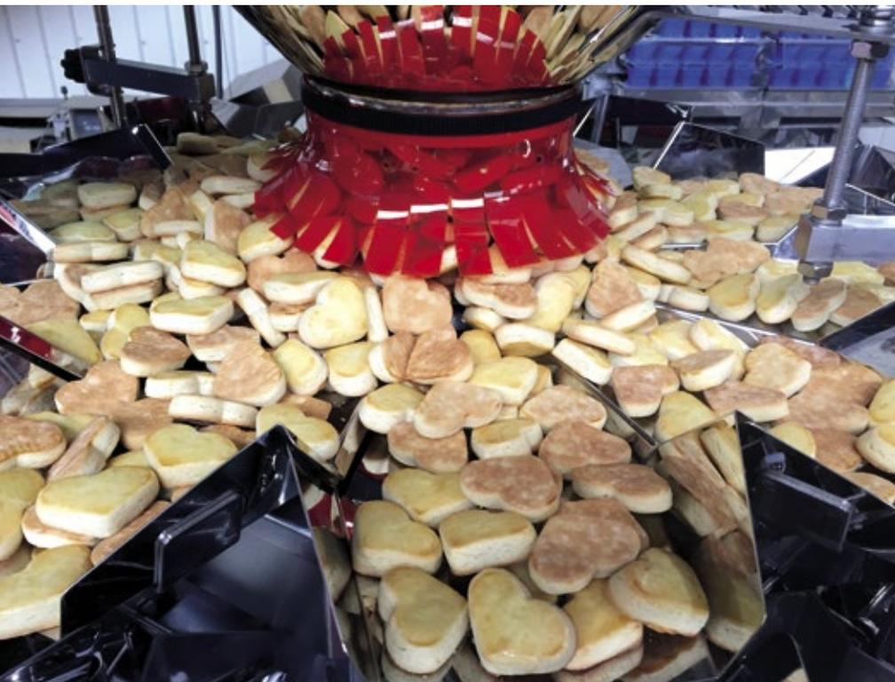
■ **Abb. 1:** Mehrkopfwagen bestehen aus unterschiedlichen Kammern, deren Inhalte zur perfekten Menge kombiniert werden.
