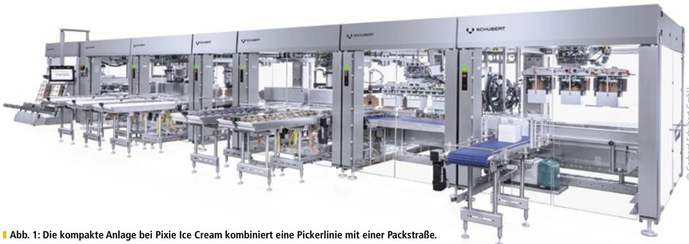
■ Abb. 1: Die kompakte Anlage bei Pixie Ice Cream kombiniert eine Pickerlinie mit einer Packstraße.
