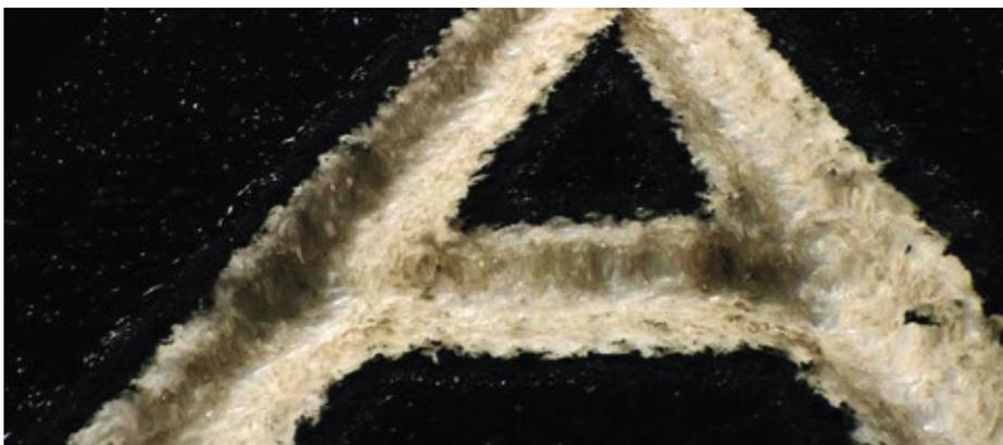
■ Abb. 1: Eine für die Laser-Kennzeichnung schlecht geeignete Oberflächentopographie von Karton.
