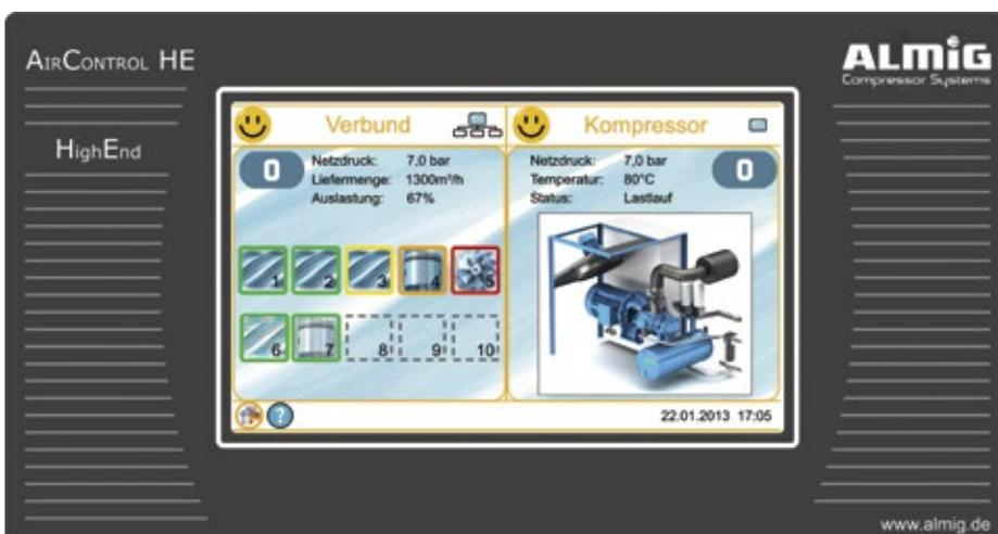
■ **Abb. 4:** Die Steuerung Almig Air Control HE regelt jeweils zwei Kompressoren im Verbund. Damit lassen sich die Energievorteile der Drehzahlregelung voll nutzen.
