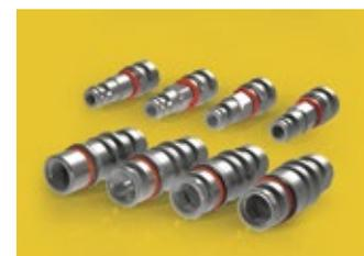
te für einen Arbeitsdruck von 0,5 bis 10 bar. Das Unternehmen bietet die Schnellschlusskupplungen in vier Ausführungen an: mit Steckcodierung rund, dreikant, sechskant oder achtkant. Eine optional verfügbare beidseitige Absperrung bietet zusätzlich ein Plus an Sicherheit.
