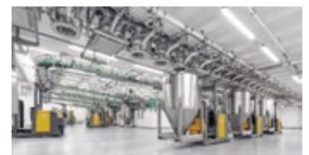
me DCS ermöglichen eine absolut kontaminationsfreie Produktion bei größtmöglicher Wirtschaftlichkeit, was gerade im Falle von vielen unterschiedlichen kundenspezifischen Rezepturen entscheidend ist. Sie ermöglichen zudem eine allergenfreie Produktion. Die Container sind mit besonderem Augenmerk auf Detailgenauigkeit und Hygienic Design ausgeführt.
