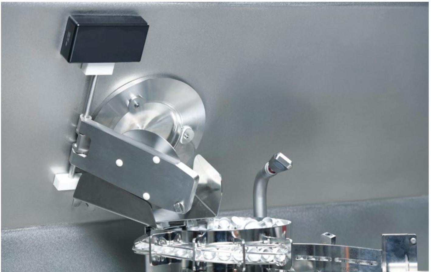
■ Abb. 1: Der PMS Ultraschallsensor reguliert den Volumenstrom von Verschlusskappen.
