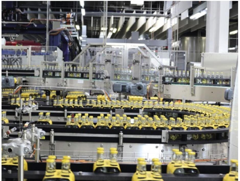
■ Abb.2: Druckluft findet sich überall im Betrieb. Sie dient als Antriebsenergie sowie als Steuerungsluft für Ventile und Zylinder.
