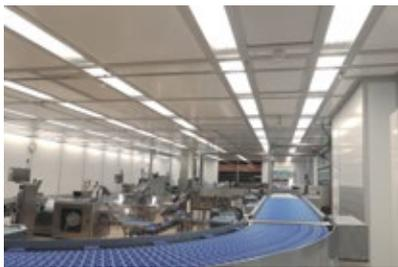
ausgestattet. Durch das Zusammenspiel von innovativer Umlufttechnik, hochgradiger Dichtheit und wartungsarmer Komponenten sind die Reinräume äußerst sicher und effizient. Wand- und Deckenelemente des Reinraums sind mit einem patentierten silikonfreien GMP Dicht-Clip-System verbunden, was den Vorteil von flexiblen Erweiterungs- oder Rückbaumöglichkeiten bietet.
