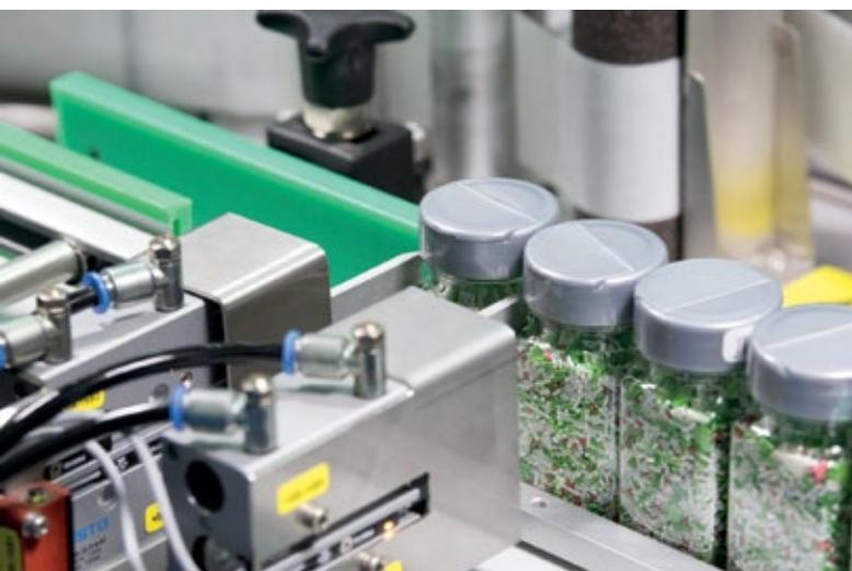
■ Abb. 3: Eine pneumatische Wechselseinzelung garantiert, dass sich die Fläschchen immer im gleichen Abstand über das Band bewegen.
