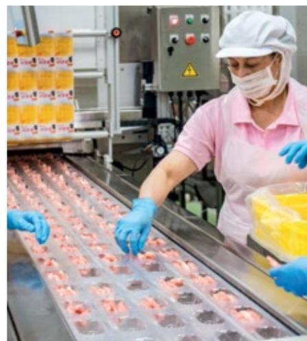
■ Abb. 3: Der Einlegebereich der R 245 wurde so verlängert, dass vier bis sechs Mitarbeiter die Produkte manuell in die Packungsmulden einlegen können. So konnte der Output der ohnehin sehr leistungsfähigen Maschine nochmals erhöht werden.
