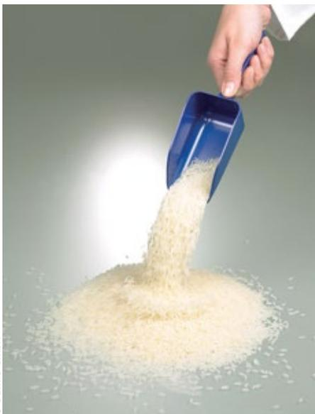
■ Abb. 2: Die detektierbaren Einweg-Probenehmer sind aufspürbar per Farbscanner, Metalldetektor oder Röntgenstrahlen.
