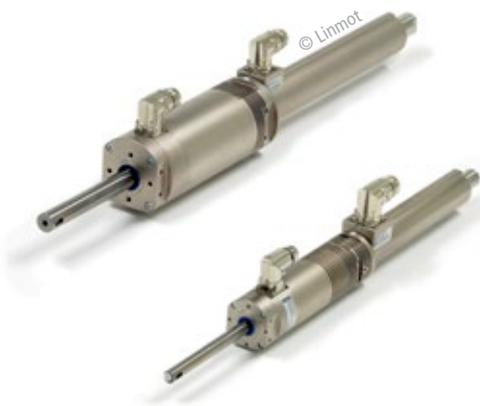
■ **Abb. 2:** Die komplett in Edelstahl gekapselten Linearmotoren der Serie P01-48 von Linmot sind bewusst kompakt gehalten und vereinen in einem Gehäuse einen rotativen und einen linearen Direktmotor, die unabhängig voneinander angesteuert werden können.
