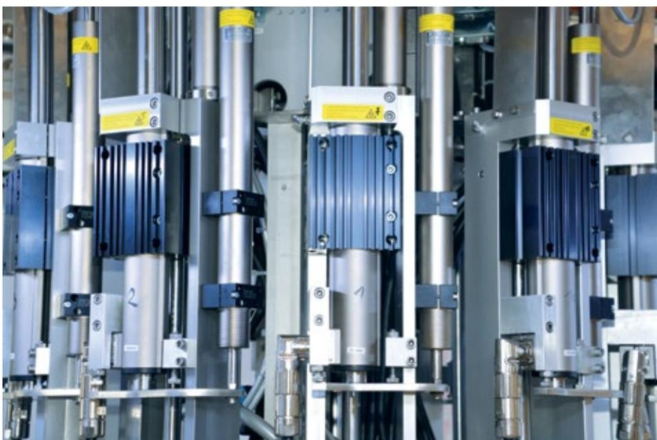
■ **Abb. 3:** Magnetische Federn (im Bild rechts vom dunkelblauen Kühlkörper) kompensieren das Eigengewicht der Verschleißspindeln und halten sie auch bei Stromunterbrechung in sicherer Position.
