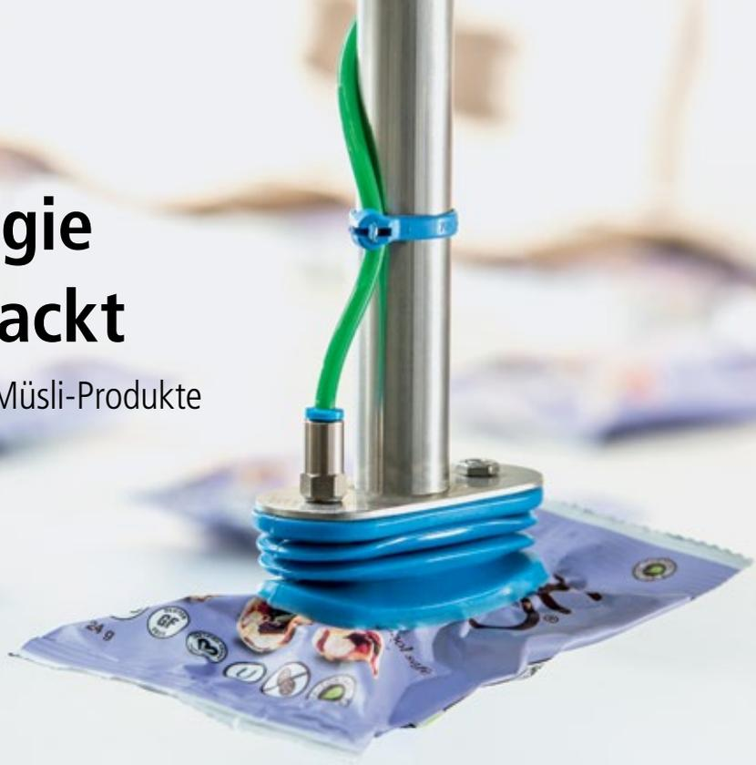
■ **Abb. 1:** Ein Roboter platziert die Snackbeutel Granola Minis in Vierer- und Fünfer-Kartons sowie in Großverpackungen mit 28 Produkten.
