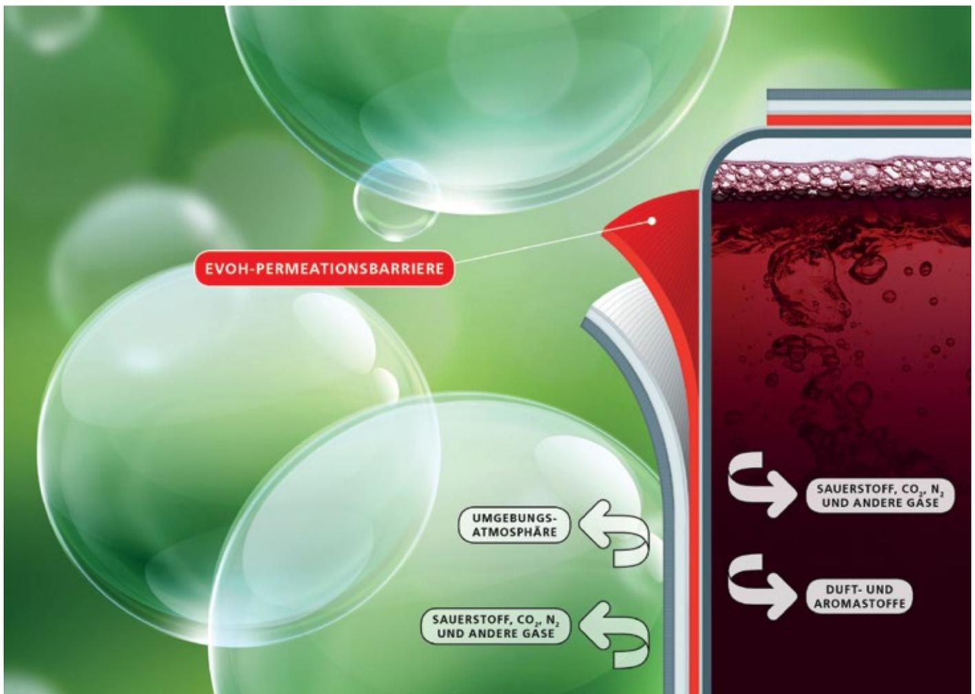
Abb. 1: Die EVOH-Barriere verhindert die Permeation von Gasen und ermöglicht somit eine kontrollierte Sauerstoffzufuhr.
