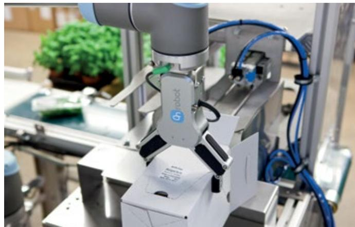
■ **Abb. 3:** Lasten von bis zu sechs Kilogramm kann der neue kollaborierende Greifer von Onrobot, der RG6, mit einer anpassbaren Kraft zwischen 25 und 120 Newton bewegen.
