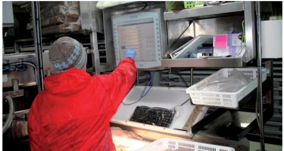
■ **Abb. 3:** Der S15G2 und S19 von Noax besitzen 20 frei programmierbare Funktionstasten am Frontrahmen, die eine schnelle und sichere Dateneingabe ermöglichen.
