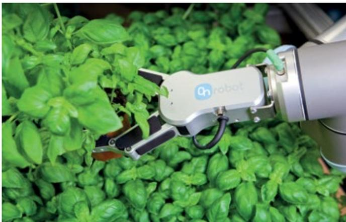
■ **Abb. 2:** Die kollaborierenden Greifer von Onrobot lassen sich sehr schnell und einfach nach dem Plug & Play-Prinzip mit den kollaborierenden Armen von Universal Robots verbinden und in Betrieb nehmen.
