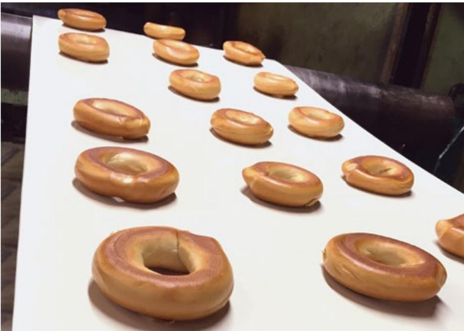
■ Abb. 3: Fördergurte mit einer weißen Deckplatte gewährleisten den Schutz von Lebensmitteln beim Transport wie z. B. Zucker, Backwaren und Getreide.
