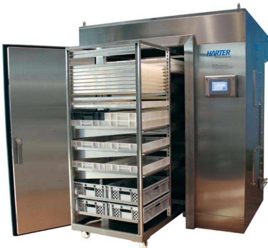
■ Abb. 1: Der Airgenex food Hordentrockner verfügt über einen multifunktionalen Hordenwagen, in dem Lebensmittel entweder auf Blechen oder abwechselnd in Wannen schonend getrocknet werden können.
