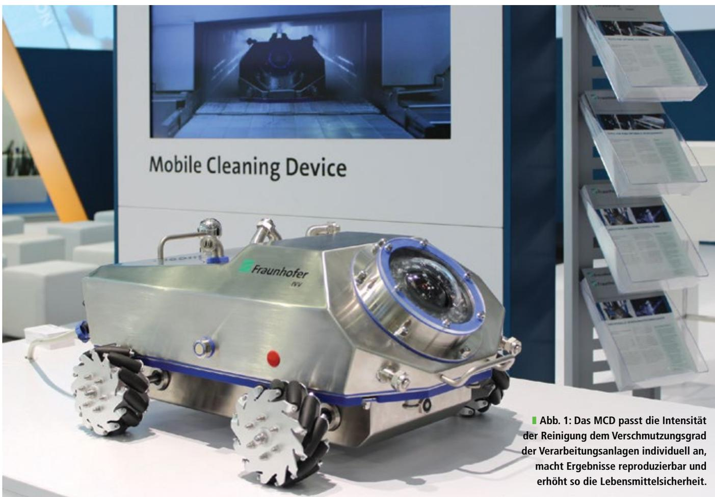
■ Abb. 1: Das MCD passt die Intensität der Reinigung dem Verschmutzungsgrad der Verarbeitungsanlagen individuell an, macht Ergebnisse reproduzierbar und erhöht so die Lebensmittelsicherheit.
