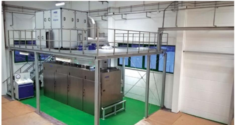
■ Abb. 2: Mandeln werden hier in Containern auf eine Restfeuchte von < 5% getrocknet, um sie anschließend vermahlen zu können.
