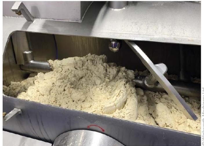
■ Abb. 3: Zu viel Scherung beim Mischen kann die zerbrechlichen Strukturen der Partikel brechen, die dafür sorgen, dass das Produkt erstarrt und eine dichte, fleischige Textur aufweist.
