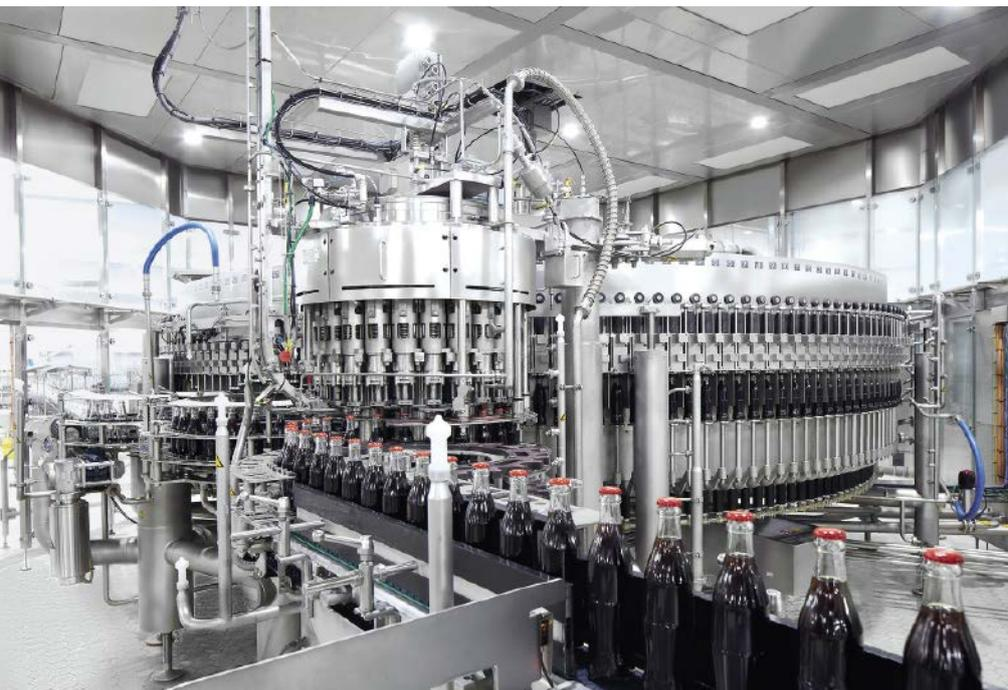
■ Abb. 1: Teil der Glaslinie in Mannheim ist der KHS-Füller Innofill Glass DRS, der bis zu 60.000 Flaschen pro Stunde verarbeiten kann.
