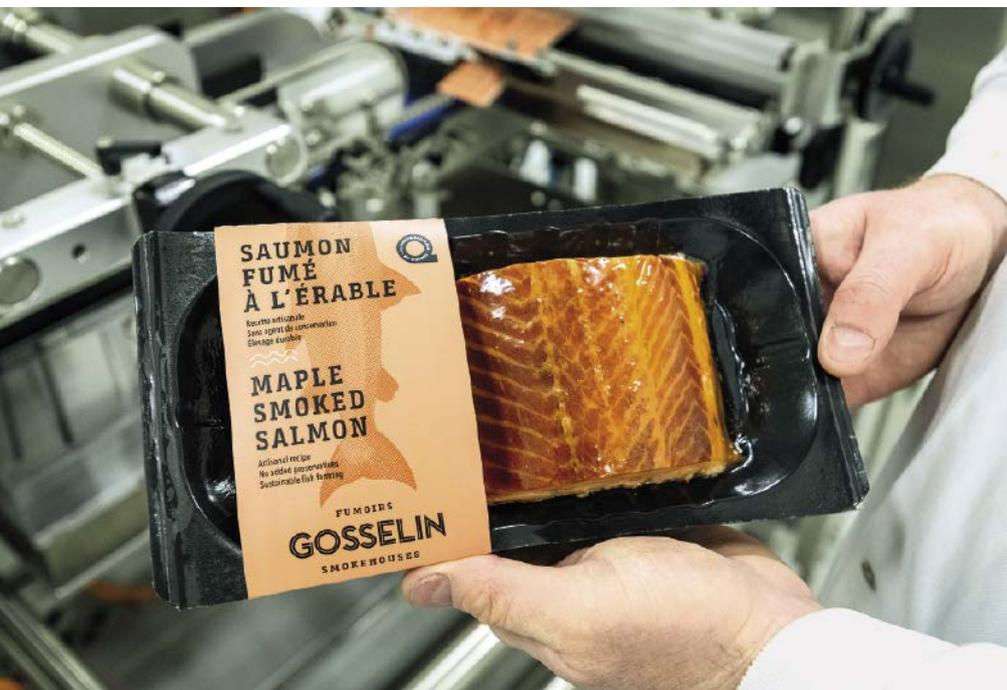
■ Abb. 1: Die Verpackung aus der Multivac Verpackungsmaschine R 105 MF präsentiert den Maple-Räucherlachs hoch transparent auf einer recyclingfähigen Unterfolie, tiefgezogen zu einer schwarz eingefärbten Schale, hinter einer sehr dünnen, flexiblen Oberfolie.
