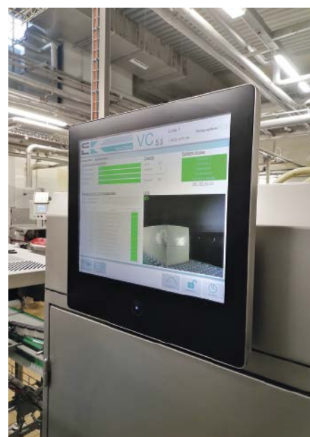
■ Abb. 2: Die Software von CLK schaut sich das spezielle Muster von dichten/undichten Verpackungen an. Ist die Struktur der Folie glatt, deutet das auf eine Undichtigkeit hin.
