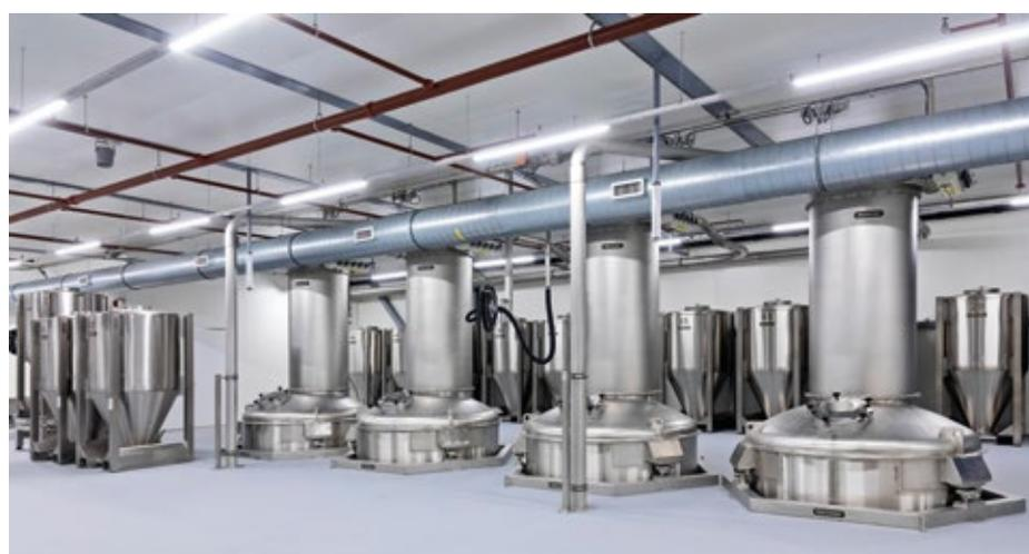
■ Abb. 3: 10.000 l Behälterwaagen über High Performance Mischlinien.
