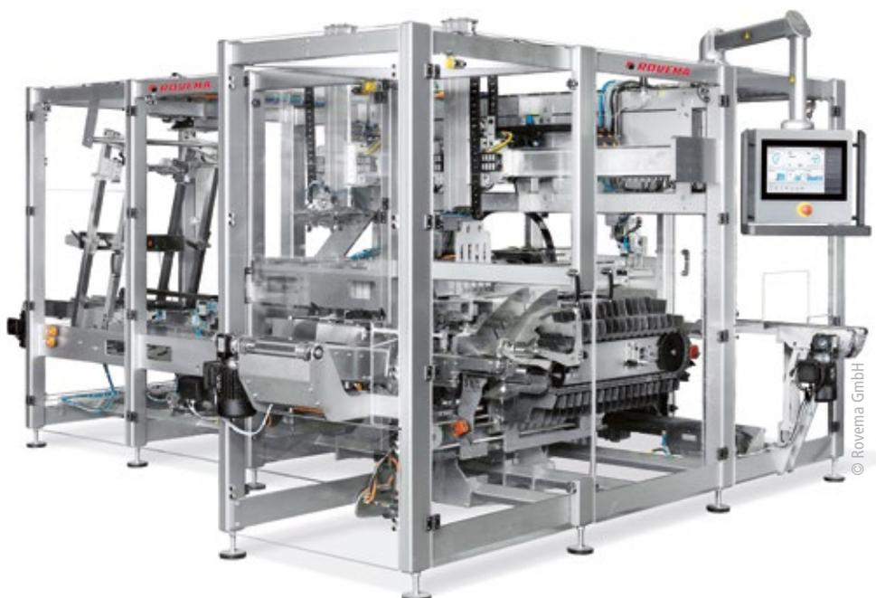
■ Abb. 1: Die ETIL-Endverpackungsmaschine für Trays mit Deckel verpackt besonders präzise und produkt schonend. Optional können elektronische Siko-Positionsanzeigen zur überwachten Formatverstellung integriert werden.
