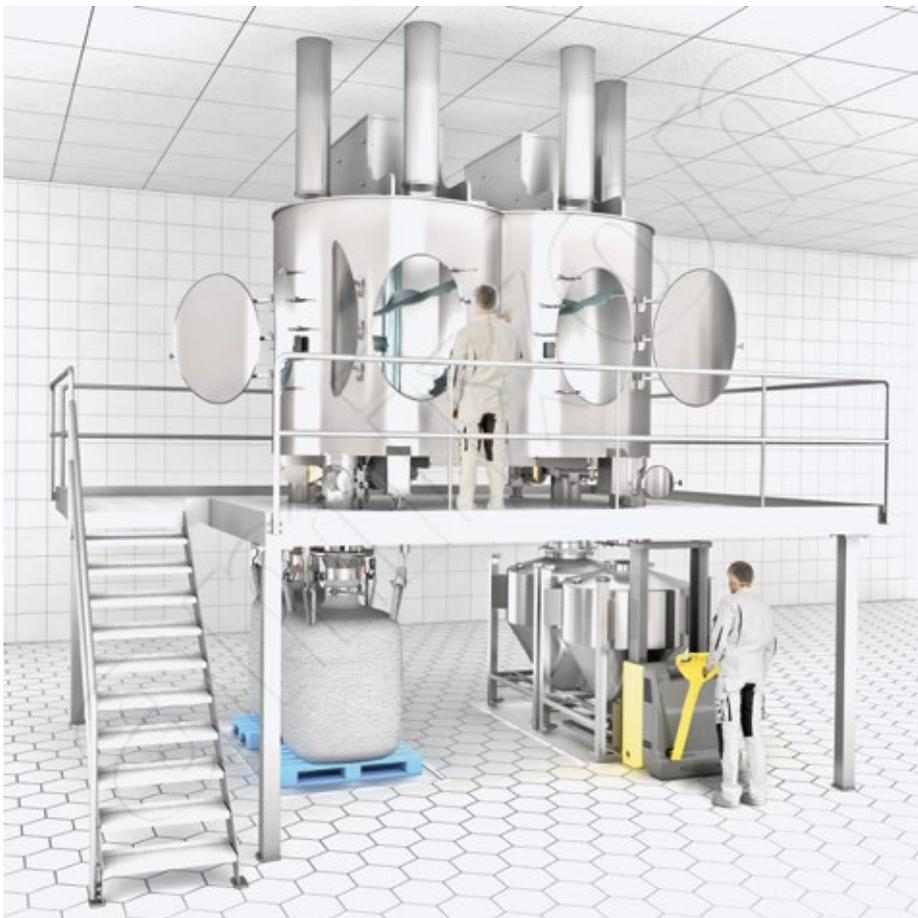
■ Abb.: Der Amixon Doppelwellenmischer eignet sich besonders für größere Chargen von etwa 2 m<sup>3</sup> bis 25 m<sup>3</sup>.
