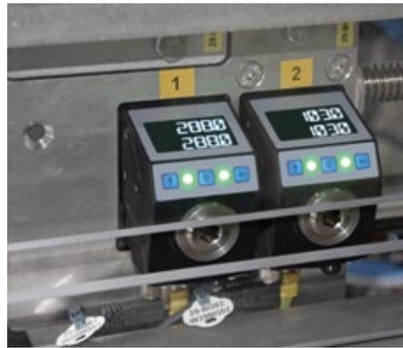
■ **Abb. 2: Elektronische Positionsanzeigen AP10 von Siko für Formatverstellungen: Die Status-LEDs leuchten grün, da Ist- und Soll-Wert exakt übereinstimmen.**
