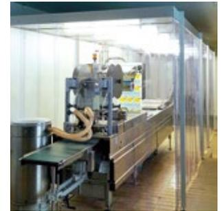
kelreinheit, Temperatur, Feuchte und Druck im gesamten Raum sichergestellt. Die Reinräume entsprechen den Vorgaben der pharmazeutischen Industrie. Eine Alternative für kleinere Verpackungs- und Abfüllvorgänge bieten die Reinraumzelte Clean Flow Cell. Hochleistungsfilter und gezielte Luftströmungen sorgen für eine Verdrängung der unreinen Luft und verhindern Kontaminationen. Die Zelte sind frei tragbar und können auf Rollen bewegt werden.
