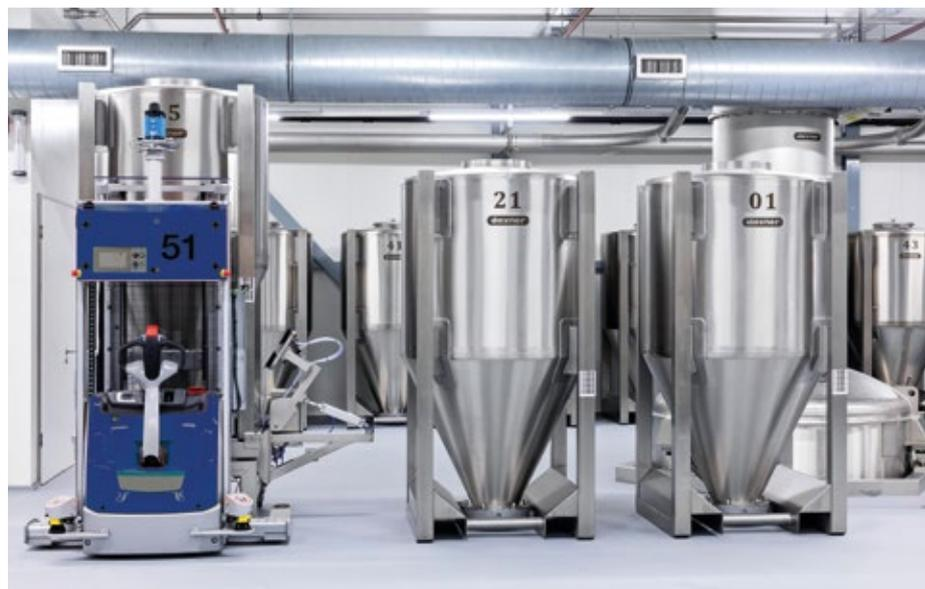
■ Abb. 2: Automatischer Container Transport mittels fahrerlosem Transportsystem FTS.
