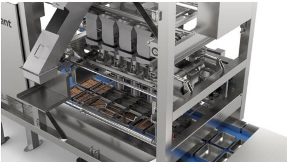
■ Abb. 3: Der Wurstableger bewegt und positioniert die Würstchen in sanften Vibrationen, dadurch ist der Schaden an den Produkten praktisch gleich null.
