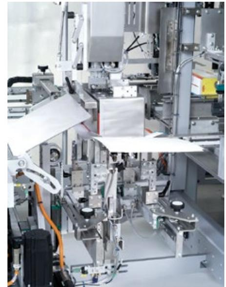
**Abb. 2:** Der Sammelpacker Elematic 2001 zeichnet sich durch sein kompaktes, ergonomisches und einfaches Maschinenendesign aus. Im Vergleich zum Vorgängermodell, der Elematic 2000, benötigt die neue Anlage 25 % weniger Platz.
