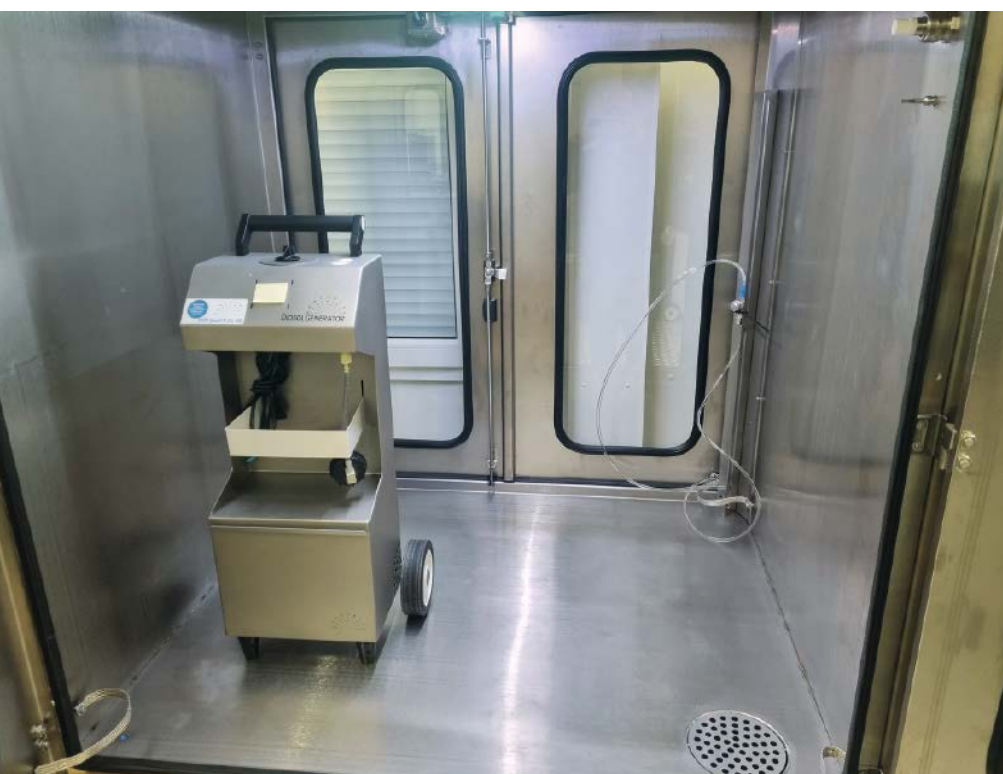
■ Abb. 1: Speziell für Fleischwarenverarbeitung bietet Desinfektionsexperte DIOP weltweit erstmals Kabinen (hier nur beispielhaft mit Generator beladen) zur gezielten Equipmenthygiene an.
