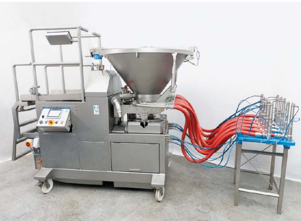
■ Abb. 1: Der mobile „Füller Typ Disk“ von Holmatec dosiert flüssige bis pastöse Produkte an bis zu zwölf Füllstellen mithilfe von lediglich einer einzigen Steuerscheibe.
