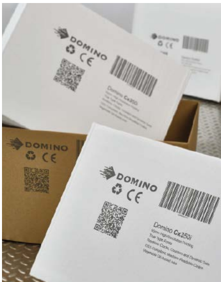
■ Abb. 2: Druckmuster des Cx350i. Das Codierungssystem wurde so optimiert, dass der Tintenverbrauch für Barcodes (200 dpi) im Vergleich zu Umverpackungsdruckern der vorherigen Generation von Domino um 33 % reduziert ist.
