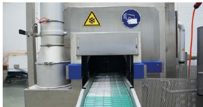
■ Abb. 3: Das Herzstück des Zip-Roll-Frosters ist die perforierte Drehtrommel. Das kryogene Gas wird von unten durch den Produkteinlauf in die Drehtrommel geblasen. Dieser Luftstrom wirkt wie ein „Luftkissen“, auf dem die Lebensmittel gefrostet werden.
