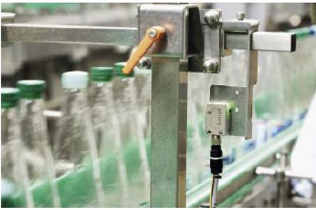
■ **Abb. 4:** PRK 18B in der Behälterfördertechnik.
