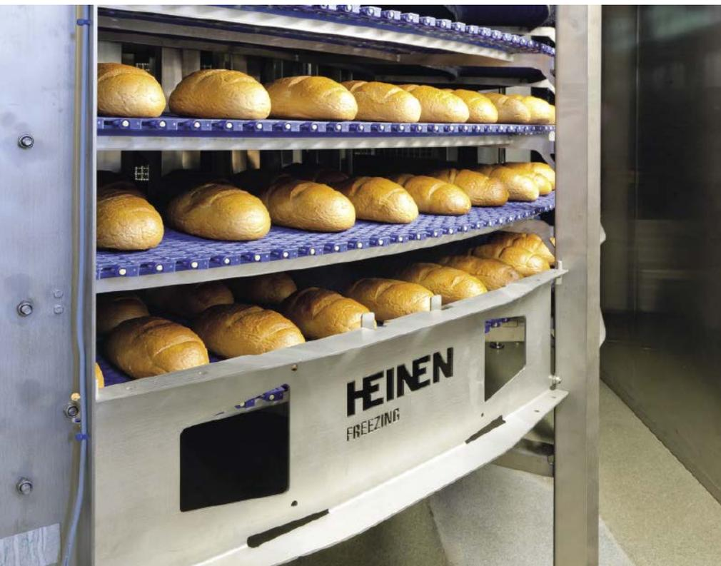
■ Abb. 1: Brot wird im Acticool gekühlt, einem Spiralsystem mit konditioniertem Klima, unterschiedlichen Bandbreiten und Etagenabständen sowie verschiedenen Optionen.
