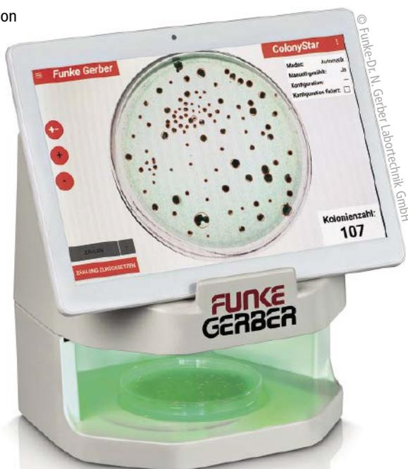
■ **Abb. 2:** Der intelligente, intuitive Colonystar automatic ist für alle Petrischalen bis zu einem maximalen Durchmesser von 9,5 cm geeignet und kann in sämtlichen mikrobiologischen Laboren eingesetzt werden.
