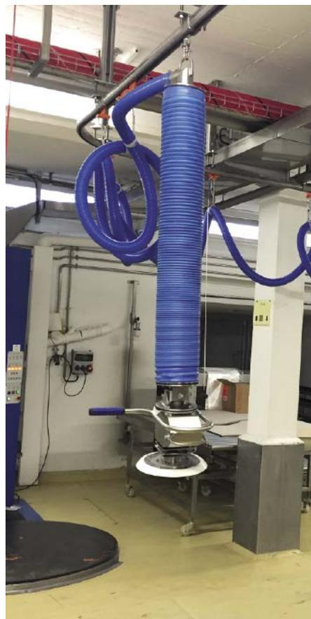
■ **Abb.:** Der Vakuumheber Ezzfast für das Handling von Säcken, Fässern und Kartons in der Lebensmittelindustrie.
