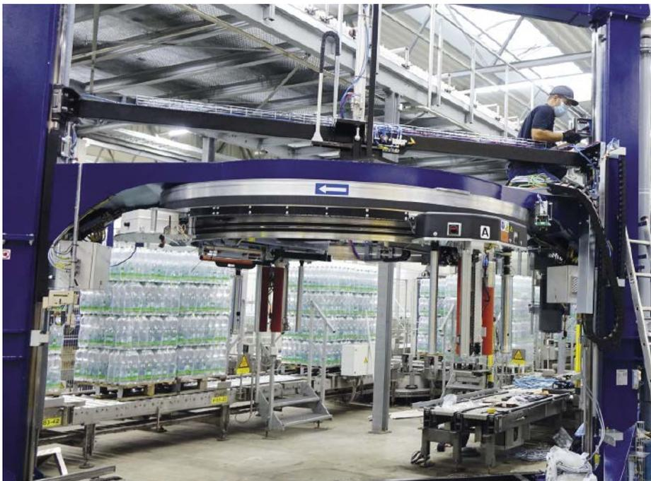
■ **Abb. 2:** Bei der Entwicklung der Genesis Thunder wurde darauf geachtet, dass die vertikale Bewegung des Rings, welche beim Verpacken parallel zur horizontalen Kreisbewegung der Führung entlang des Rings abläuft, durch ein Gegengewichtssystem maximal beschleunigt und gleichzeitig harmonisiert wird.
