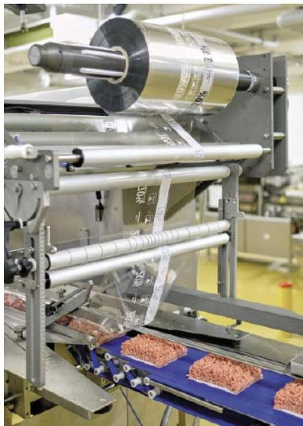
■ Abb. 2: Um den Flow-Pack-Verpackungsprozess zu optimieren, wurde die Faltgeometrie der Folie verändert.
