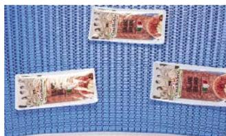
selbst bei Nassanwendungen konstant hohe Leistung. Außerdem kommt das System ohne kleinteilige Verschlusselemente aus. Das doppelreihige Zahnrad ermöglicht problemlosen Reversierbetrieb und sorgt für perfekte Leistungsübertragung. Die Serie 18 passt auf viele bestehende Fördererkonfigurationen und kann direkt in bestehende Fördersysteme eingebaut werden.
