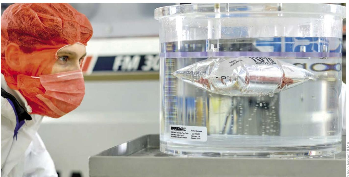
■ Abb. 3: Stichprobenartig überprüft das Feneberg-Team, hier Produktionsleiter Christian Gareiß, die Dichtigkeit der Flow-Pack-Verpackung.
