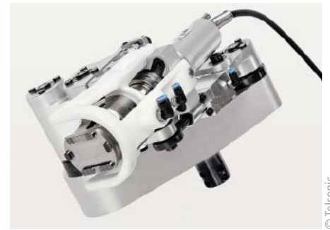
■ Abb. 3: Durch die Pins der Sonotrode wird der Faden an verschiedenen Punkten mit genau definiertem Druck am Vlies befestigt.
