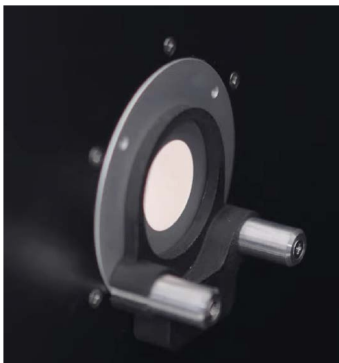
■ Abb. 2: Dieses Bild zeigt die Probenkammer, in der entweder feste oder flüssige Proben (in Küvetten) schnell und einfach montiert/geklemmt werden können.
