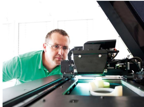
Abb. 2: Die 3D-Drucker bei Pöppelmann können innerhalb weniger Stunden Prototypen aufbauen, die so „begreifbar“ werden.
