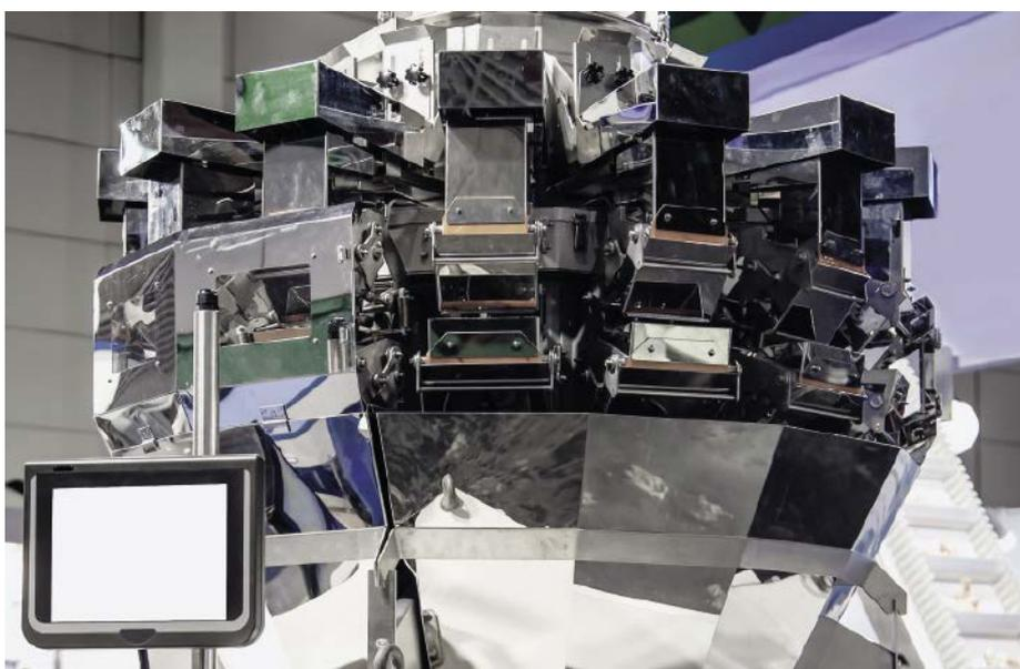
■ Abb. 1: Die QS von Abfüll- und Verpackungsprozessen mit hohen Taktzahlen, wie z.B. die Abfüllung an Mehrkopfwagen, profitiert von der Analyse von blitzschnellen sporadischen Ereignissen.
