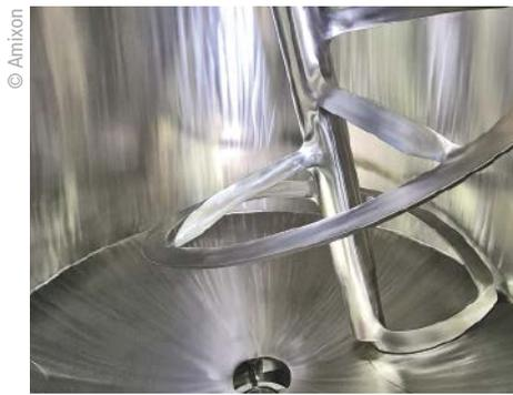
■ Abb. 3: Mischraum und Mischwerk des Gyraton Mixers.
