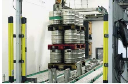
■ **Abb. 3:** Leuze Mehrstrahl-Sicherheits-Lichtschranken des Typs MLD 500 sichern den Arbeitsbereich der Roboter gegen Zugang von außen ab.
